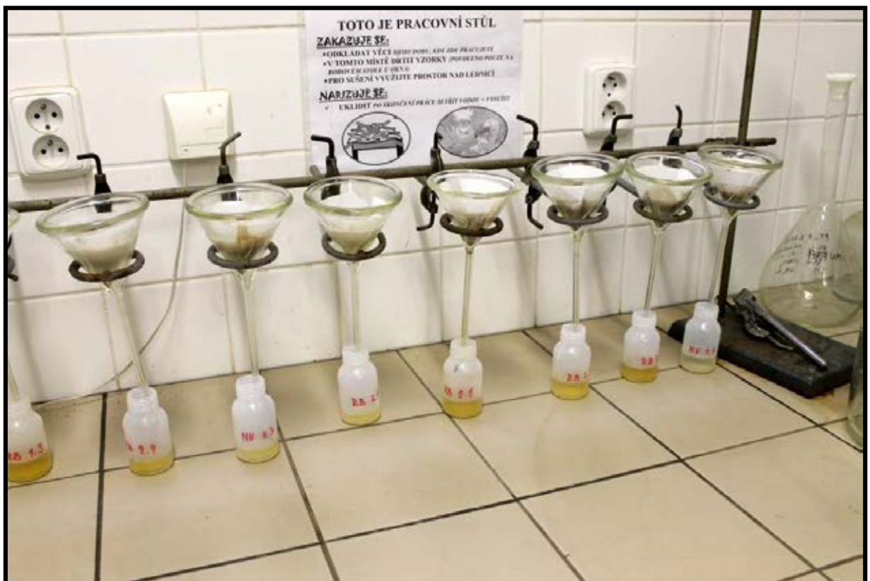
Obr. č. 14 Filtrace suspenzí vzniklých třepáním 5 g zeminy s 50 ml extrakčního činidla (19.11.2015)
