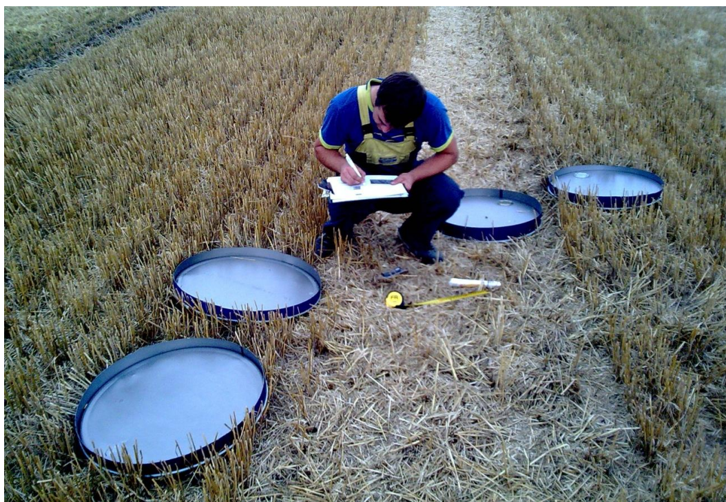
Obr. 27 – Měřicí kruhové nádoby pro zjištění ztrát sklízecího ústrojí
