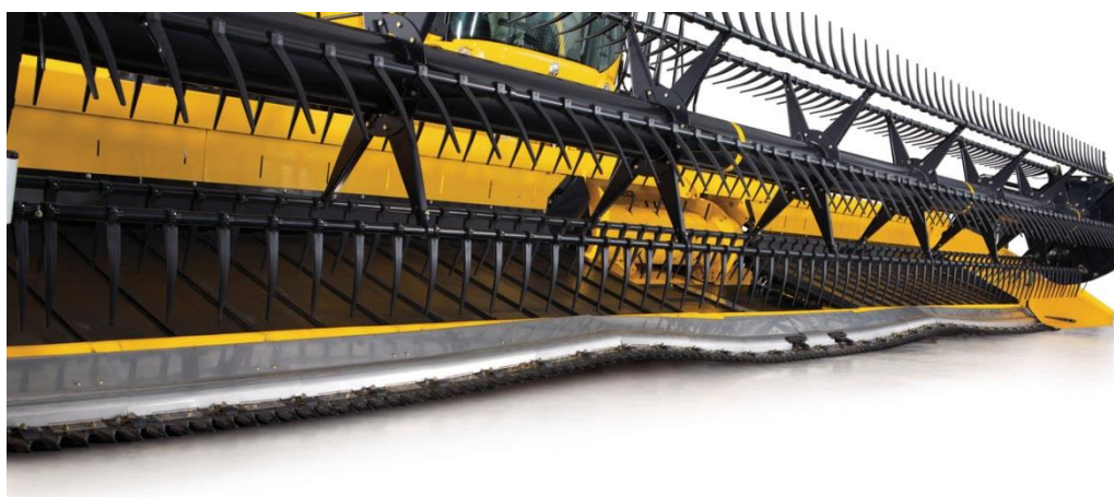
Obr. 7 – Žací ústrojí pro sklizeň luštěnin (CNH Belgium NV, 2012)
