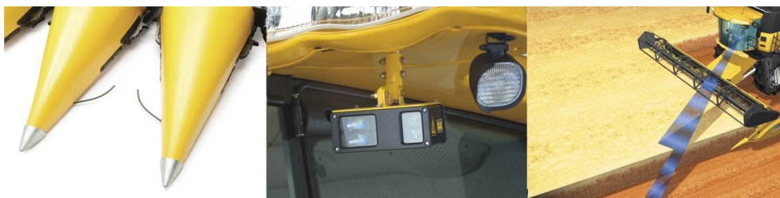
Obr. 21 – Snímače navádění sklízecí mlátičky v porostu (CNH Belgium NV, 2012)
