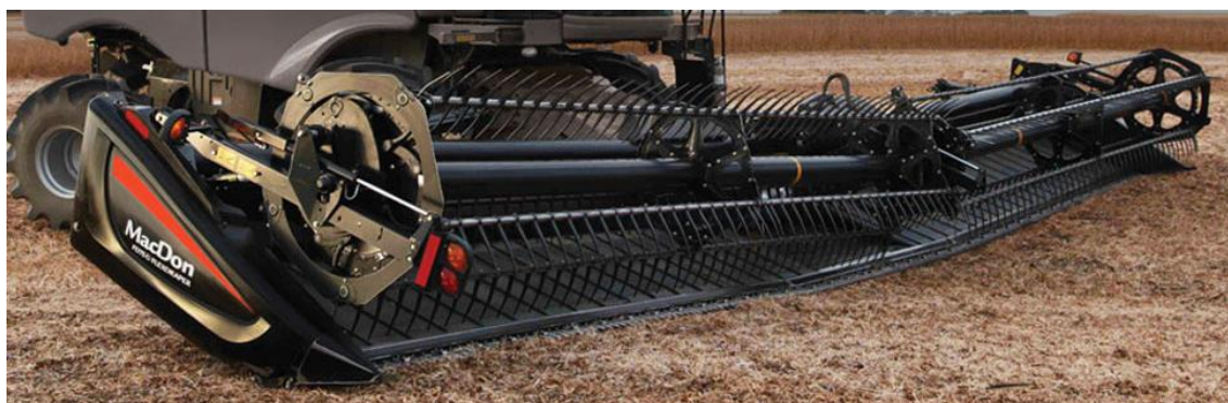
Obr. 4 – Žací ústrojí s pásovými dopravníky (Kintl, 2014)
