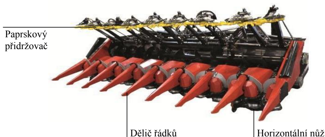
Obr. 13 – Bezřádkové sklízecí ústrojí pro sklizeň kukuřice (Lebulletin, 2013)
