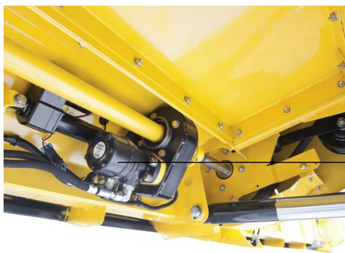
Obr. 24 – Pohon pro odblokování sklízecího ústrojí (CNH Belgium NV, 2012)
