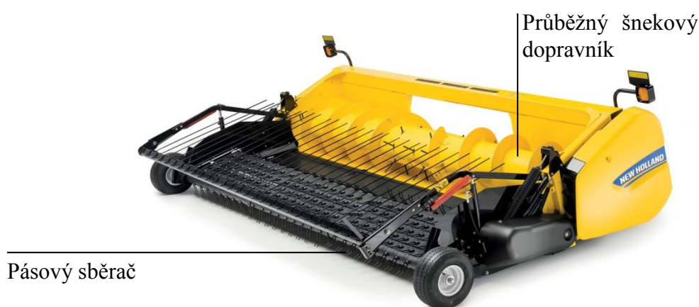
Obr. 10 – Sběrací ústrojí s pásovým sběračem (CNH Belgium NV, 2014)
