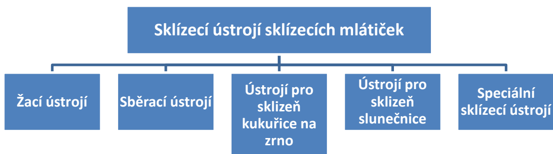
Obr. 2 – Základní rozdělení sklízecích ústrojí sklízecích mlátiček
