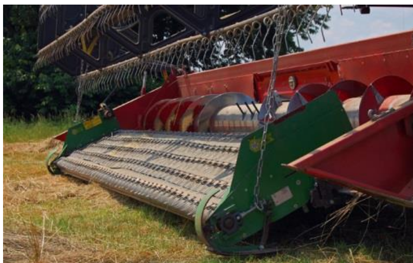
Obr. 9 – Nástavec pro dělenou sklizeň (Axial – Flow, 2010)
