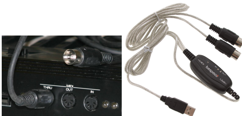
Obrázek 2.2: MIDI rozhraní a převodník
