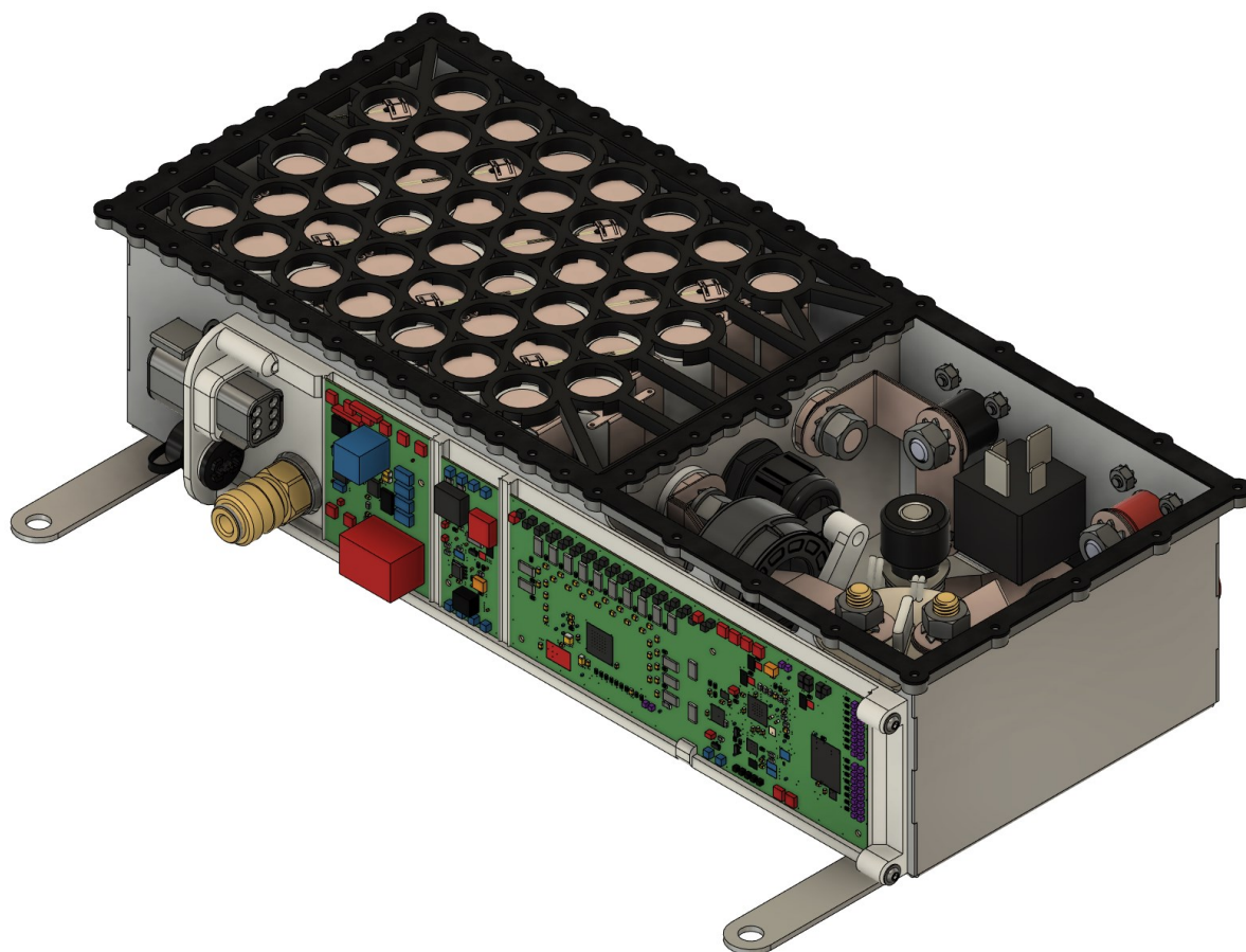
Obrázek 5.6: Finální návrh baterie s odejmutými kryty
