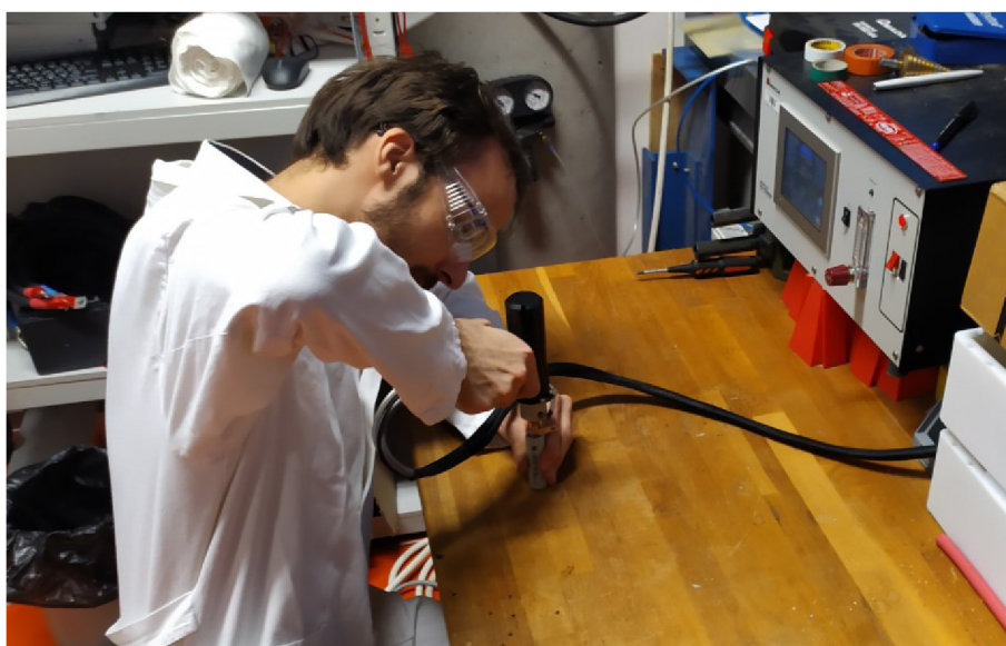
Obrázek 4.1: Demonstrace přivařování vývodů k článku technologií micro TIG
