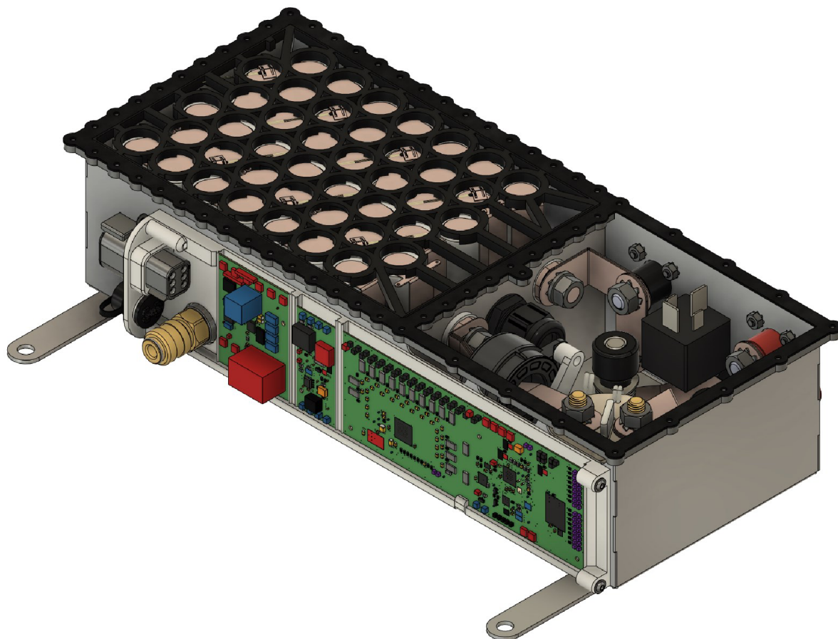
Obrázek 5.6: Finální návrh baterie s odejmutými kryty
