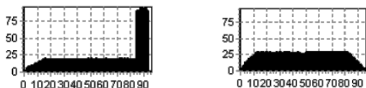
Obrázek 2.3: Vlevo: typická horizontální projekce pro trojúhelník, vpravo: vertikální
