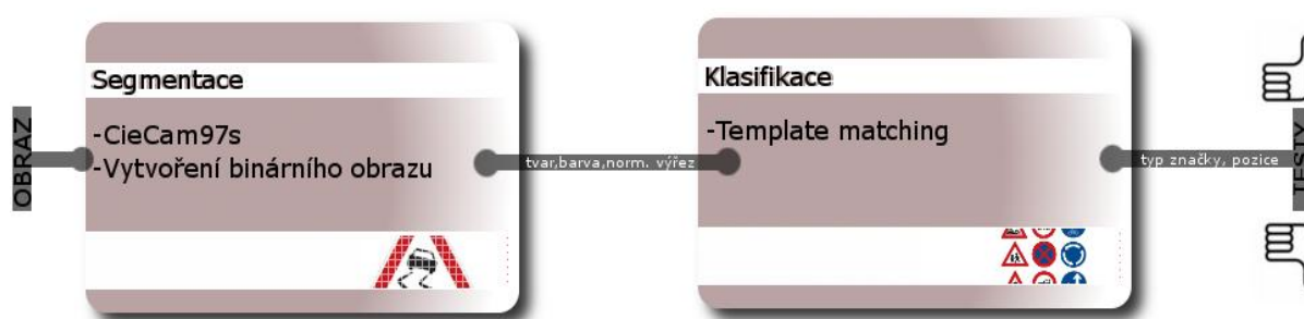
Obrázek 3.1: Návrh systému pro detekci a klasifikaci dopravních značek
