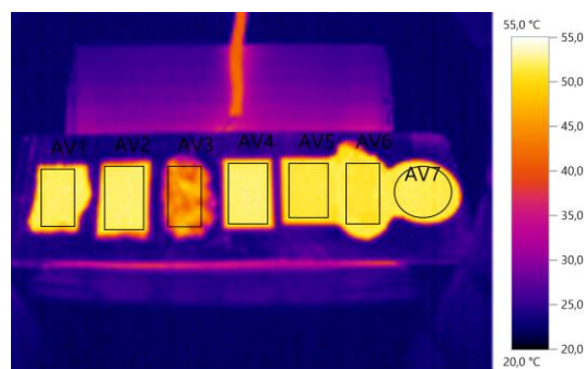
Obrázek 18: Metody zvýšení emisivity
