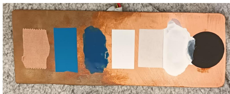
Obrázek 12: Zkušební vzorek testující metody zvýšení emisivity
