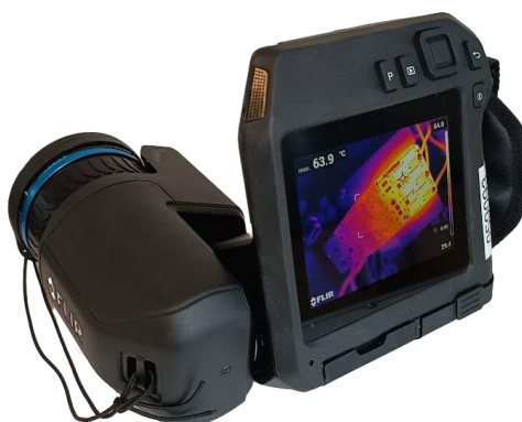
Obrázek 6: Termokamera Flir T540
