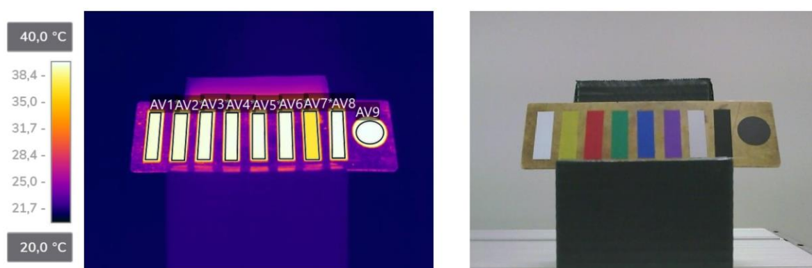
Obrázek 17: Zkušební vzorek s různými barevnými páskami
