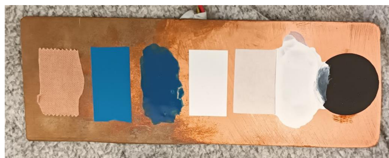
Obrázek 12: Zkušební vzorek testující metody zvýšení emisivity
