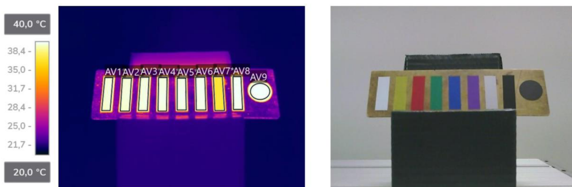
Obrázek 17: Zkušební vzorek s různými barevnými páskami
