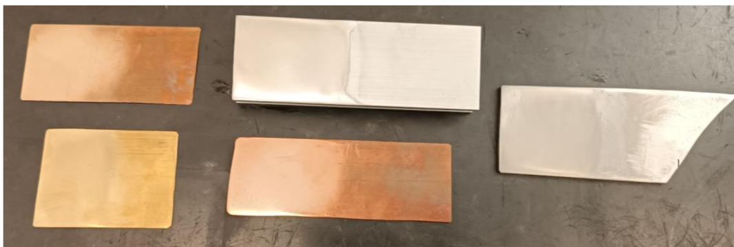
Obrázek 11: Částečně vyleštěné kovové vzorky
