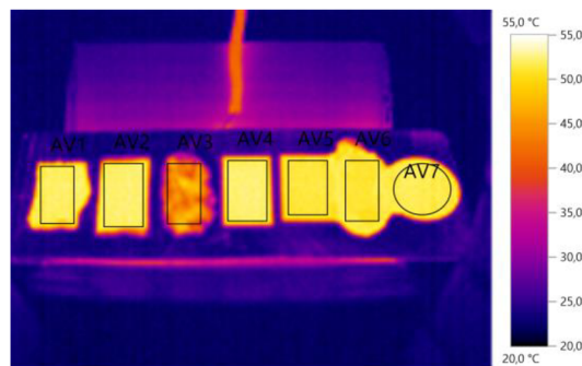
Obrázek 18: Metody zvýšení emisivity
