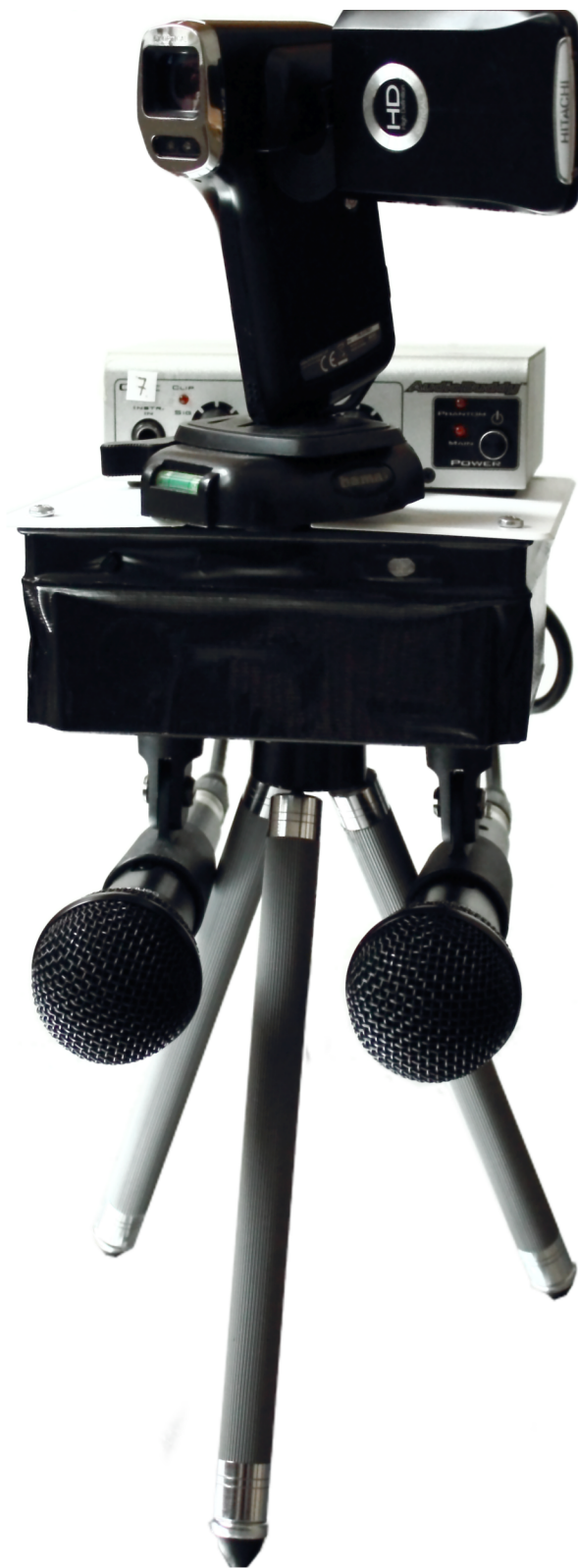
Obrázek 18: Fotografie inteligentního ovladače kamery s připevněnou kamerou
