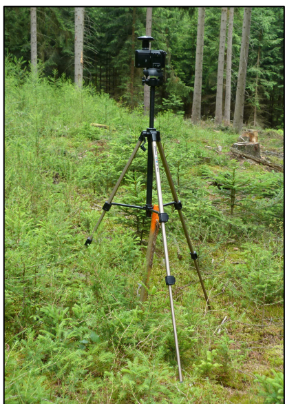
Obr. 6: Měření pomocí čočky Fish-eye a zobrazení hemisférické fotografie (Foto J.Tesař)
