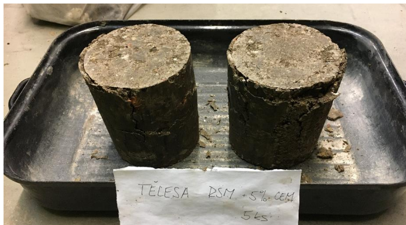
Obrázek 3.22 – Vzorky po zkoušce v tlaku – R_{C+B} 0/32 + 5 % CEM 42,5 R
