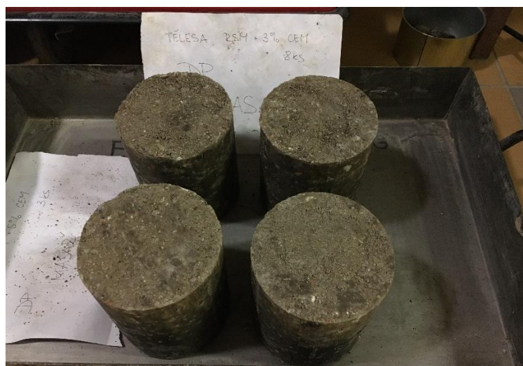
Obrázek 3.29 - Připravená zkušební tělesa ke zkoušce v příčném tahu
