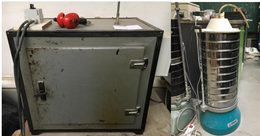
Obrázek 3.3 - Horkovzdušná sušárna a sada zkušebních sít
