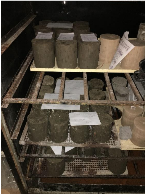
Obrázek 3.18 - Zrání zkušebních těles
