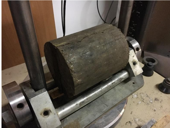
Obrázek 3.31 - Těleso po zkoušce v příčném tahu
