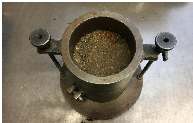
Obrázek 3.10 - Zhutněný vzorek ve formě
