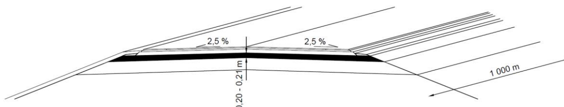
Obrázek 3.57 - Schéma komunikace S 9,5 s umístěním spodní podkladní vrstvy
