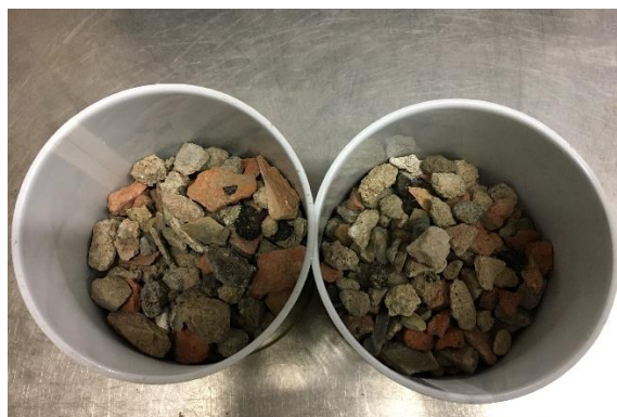
Obrázek 3.51 - Dílčí navážky připravené k měření
