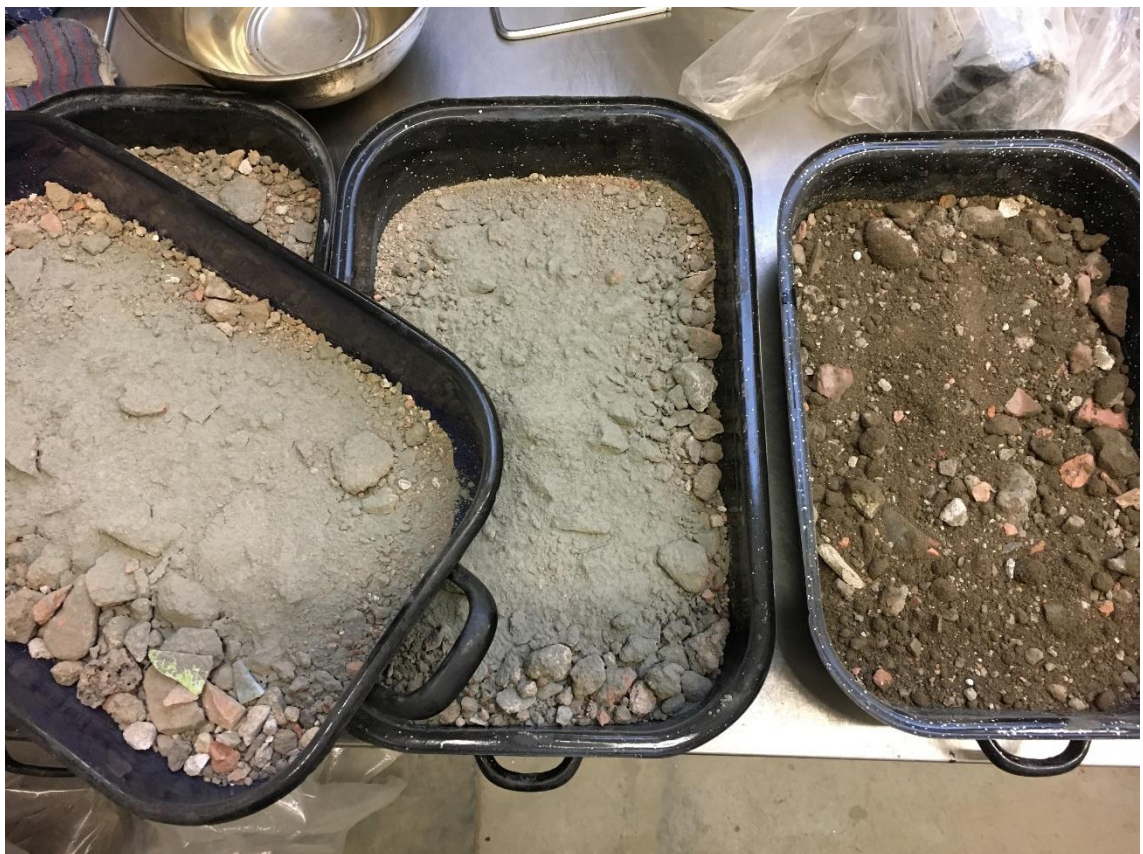
Obrázek 3.9 - Připravené směsi; vlevo bez přivlhčení; vpravo hotová směs
