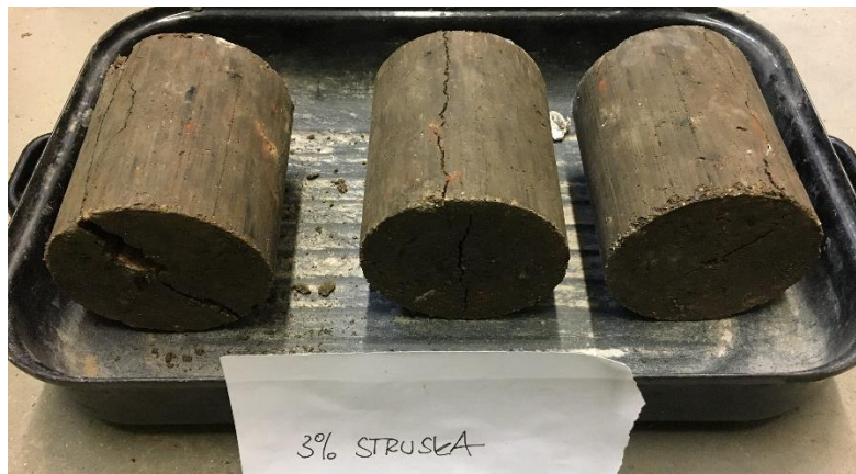
Obrázek 3.35 - Vzorky po zkoušce pevnosti v příčném tahu – R_{C+B} 0/32 + 3 % STR
