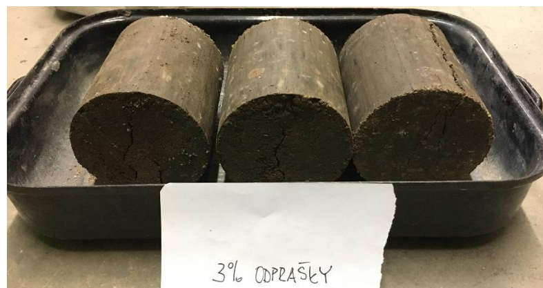
Obrázek 3.37 - Vzorky po zkoušce pevnosti v příčném tahu – R_{C+B} 0/32 + 3 % CEM ODP
