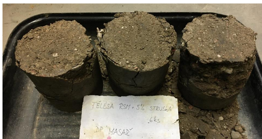
Obrázek 3.24 – Vzorky po zkoušce v tlaku – R_{C+B} 0/32 + 5 % STR
