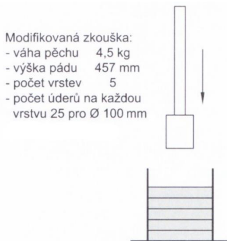
Obrázek 3.6 - Schéma principu Proctorovy modifikované zkoušky [19]
