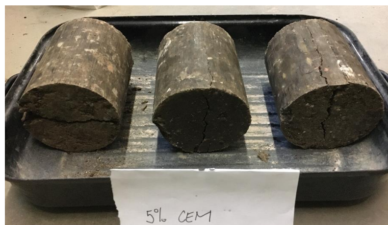
Obrázek 3.34 - Vzorky po zkoušce pevnosti v příčném tahu – R_{C+B} 0/32 + 5 % CEM 42,5 R
