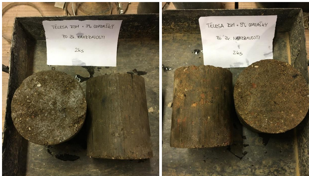
Obrázek 3.49 - Tělesa po zkoušce; zleva: s 3 % CEM ODP, s 5 % CEM ODP
