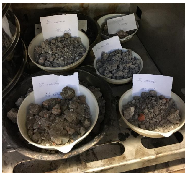
Obrázek 3.12 - Váženky se zeminou k sušení do ustálené hmotnosti
