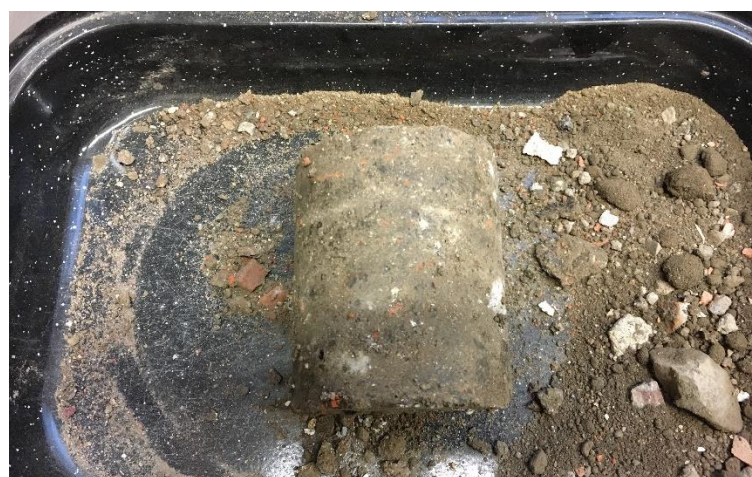
Obrázek 3.11 - Zhutněný vzorek vyjmutý z formy
