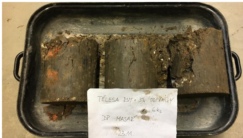
Obrázek 3.25 – Vzorky po zkoušce v tlaku – R_{C+B} 0/32 + 3 % CEM ODP
