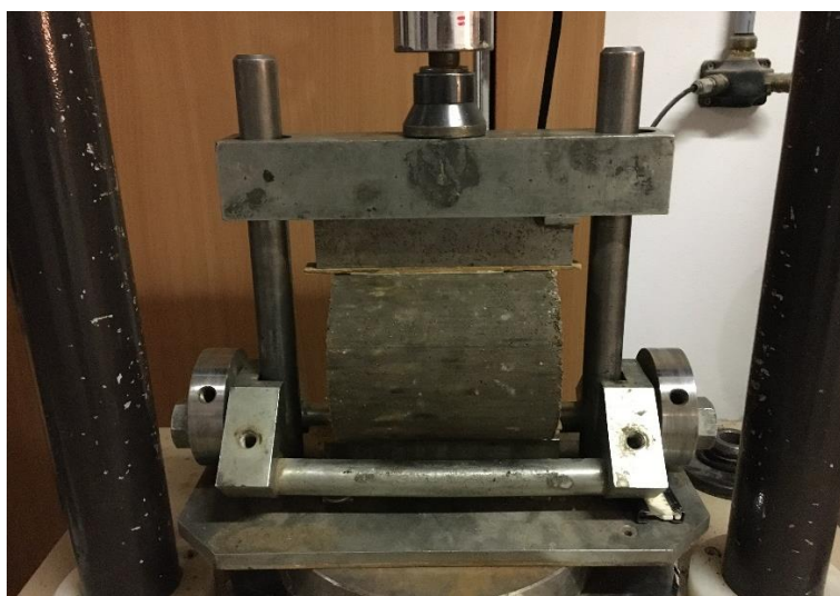
Obrázek 3.30 - Uložení zkušebního tělesa při zkoušce v příčném tahu
