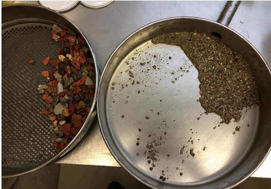
Obrázek 3.52 - Kamenivo po zkoušce odolnosti proti mrazu; vpravo na fotce propad sítem 4 mm
