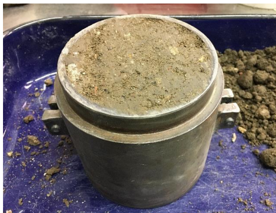
Obrázek 3.16 - Zhutněný vzorek ve formě
