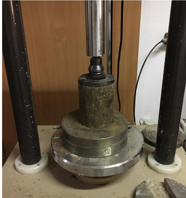
Obrázek 3.19 - Umístění zkušebního tělesa v lisu
