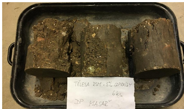
Obrázek 3.26 – Vzorky po zkoušce v tlaku – R_{C+B} 0/32 + 5 % CEM ODP
