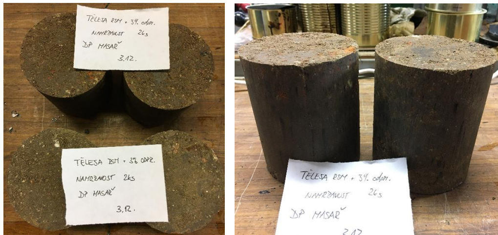
Obrázek 3.48 - Tělesa s cementářskými odprašky před zkouškou
