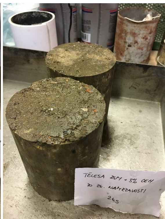
Obrázek 3.44 - Tělesa po zkoušce; zleva: s 3 % CEM 42,5 R, s 5 % CEM 42,5 R
