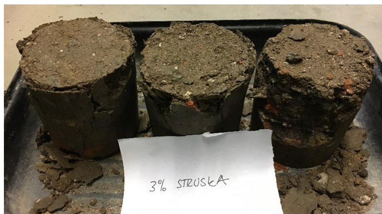
Obrázek 3.23 – Vzorky po zkoušce v tlaku – R_{C+B} 0/32 + 3 % STR
