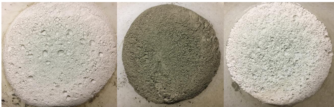
Obrázek 3.2 – Pojiva použité pro zhotovení směsí; zleva: cementářské odprašky, portlandský cement I 42,5 R, vysokopecní struska
