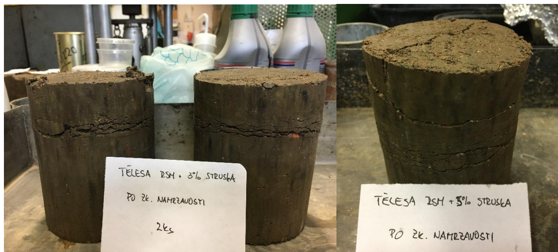
Obrázek 3.47 - Tělesa po zkoušce; zleva: s 3 % STR, s 5 % STR
