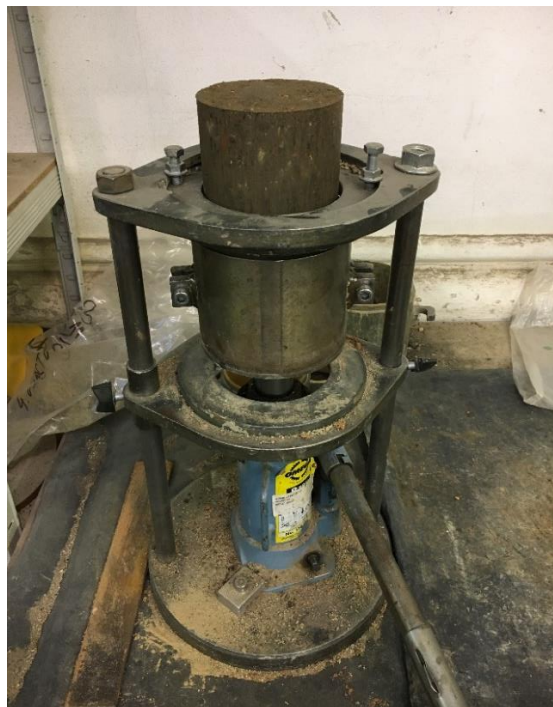
Obrázek 3.15 - Vyjímání vzorku z formy
