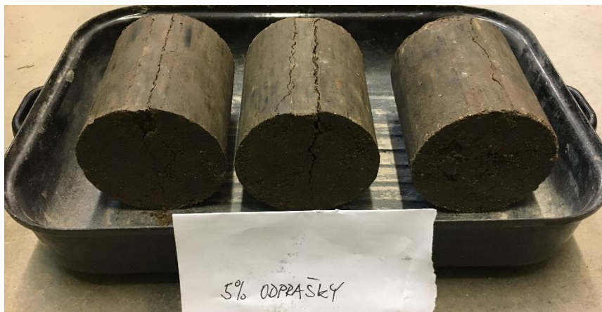
Obrázek 3.38 - Vzorky po zkoušce pevnosti v příčném tahu – R_{C+B} 0/32 + 5 % CEM ODP
