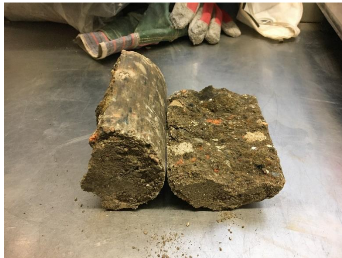
Obrázek 3.32 - Deformovaný vzorek po zkoušce v příčném tahu
