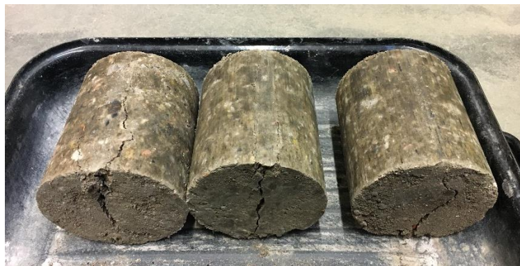
Obrázek 3.33 – Vzorky po zkoušce pevnosti v příčném tahu – R_{C+B} 0/32 + 3 % CEM 42,5 R
