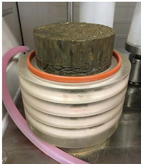
Obrázek 3.46 - Těleso porušené mrazovým zdvihem uložené ve zkušební buňce
