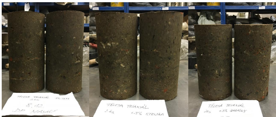
Obrázek 3.55 - Připravené vzorky k měření modulu pružnosti
