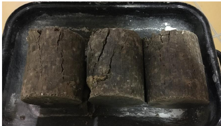
Obrázek 3.21 – Vzorky po zkoušce v tlaku – R_{C+B} 0/32 + 3 % CEM 42,5 R
