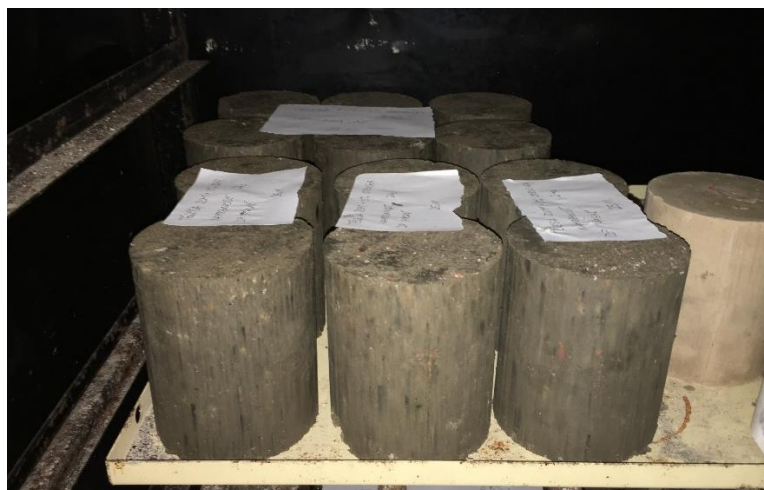
Obrázek 3.28 - Uložení zkušebních těles v komoře
