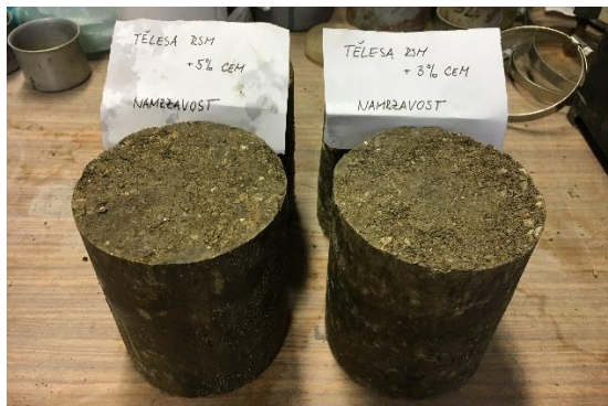
Obrázek 3.42 - Tělesa před zkouškou
