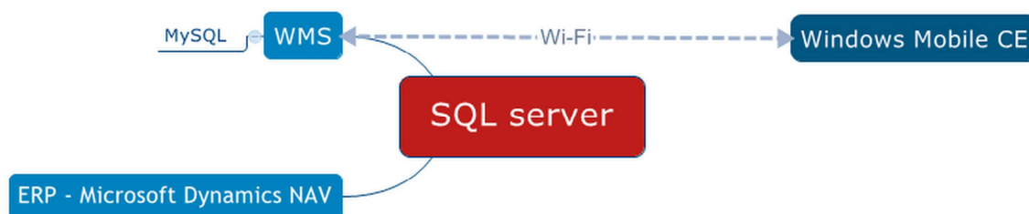
Obrázek 10: Schéma komunikace ERP, WMS, SQL, čtečky
