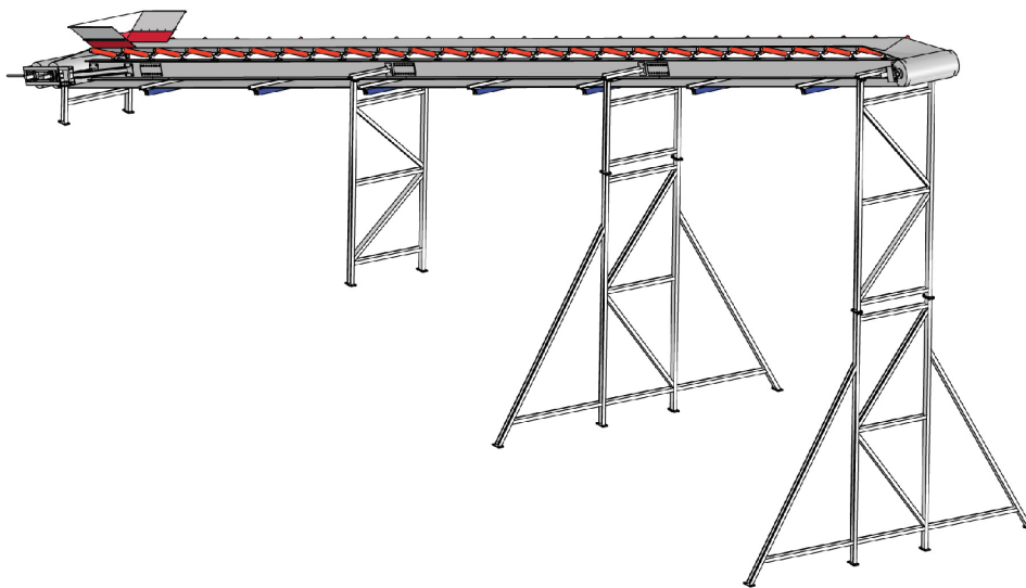
Obrázek 5.1: Navržený pásový dopravník.
