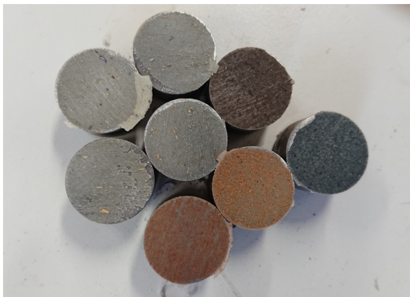
Obr. 16. Srovnání plochy lomu jednotlivých variant na odtržených tělískách.
