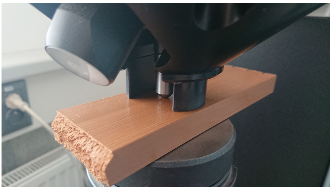
Příloha 4. Zajištění měřeného vzorku v tvrdoměru.
