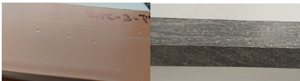
Obr. 11. Srovnání vtisků 3. a 1. varianty.
