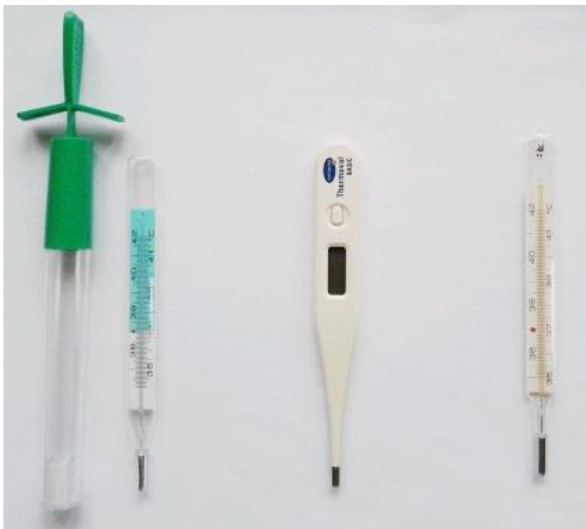
Obrázek 1- Tři druhy teploměrů zahrnuté ve studii – zleva skleněný bezrtuťový, digitální, skleněný rtuťový
