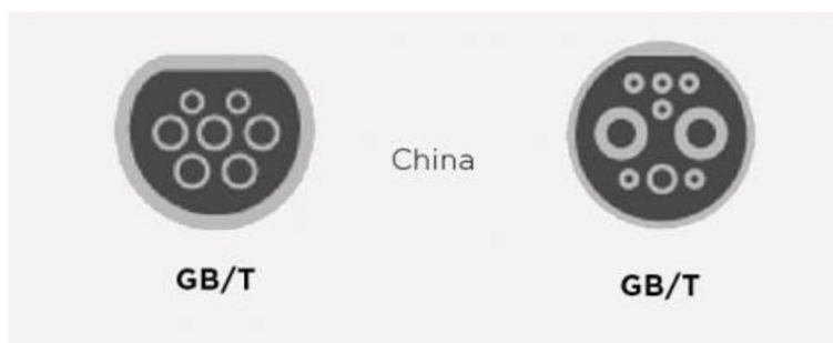
Obrázek 2: Dobíjecí konektor typu GB/T ( Attorney general's department, 2024 )
