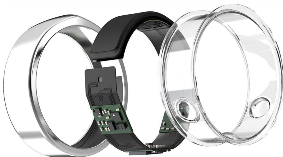
Obrázek 9. Technická ilustrace Oura Ring (Altini & Kinnunen, 2021).
