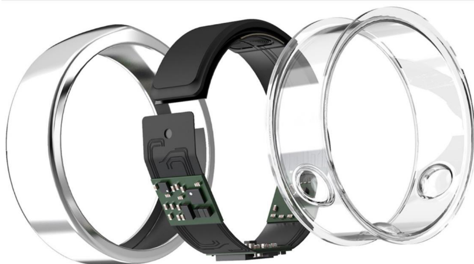
Obrázek 9. Technická ilustrace Oura Ring (Altini & Kinnunen, 2021).
