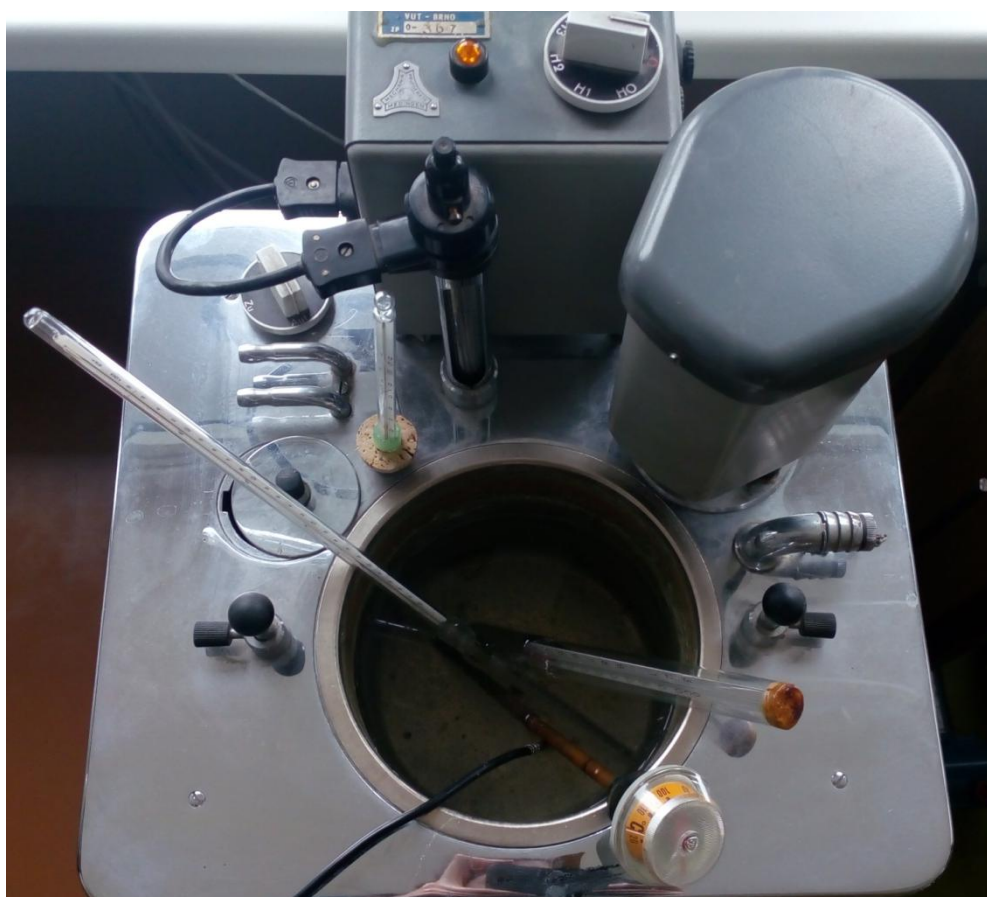
Obr. 6.2: Termostat v laboratoři ÚAI s přesným rtuťovým teploměrem, bimetalovým teploměrem a lihovým teploměrem
