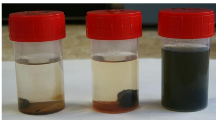
Obr. 49 Roztoky se vzorky č. 7., FeAgSi se zastoupením legujících prvků v 10%, 80% železa. Zleva Ringerův roztok, fyziologický roztok s kyselinou vinnou a NaOH o pH 3,5, fyziologický roztok s kyselinou vinnou a NaOH o pH 4,6
