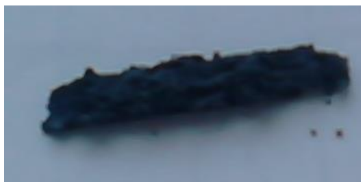
Obr. 4 Vzorek implantátu (pórovitá houba na mytí auta smíchaná s práškovým železem a žíhaná na maximální teplotu 1000°C po dobu 30 minut, na 400°C s pauzou 30 minut)
