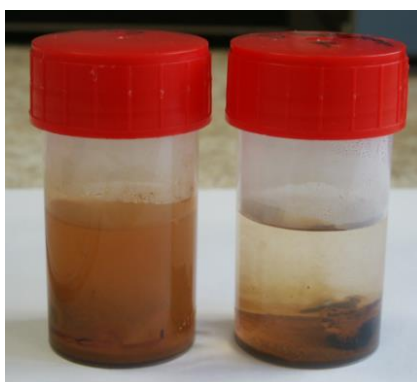
Obr. 48 Roztoky s vzorky č. 5., FeAgSi se zastoupením legujících prvků v 5%, 90% železa. Zleva fyziologický roztok, fyziologický roztok s peroxidem vodíku
