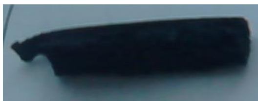
Obr. 6 Vzorek implantátu (houbička na nádobí smíchaná s práškovým železem a žíhaná na maximální teplotu 1000°C po dobu 30 minut, na 400°C s pauzou 30 minut)
