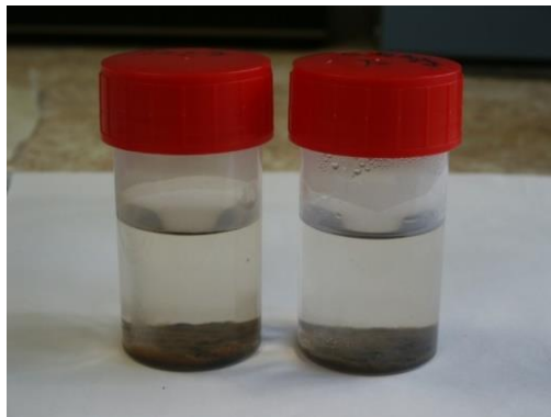
Obr. 43 Roztoky, ve kterých byly uloženy vzorky číslo 6, FeAgMg se zastoupením legujících prvků v 5%, 90% železa. Vlevo fyziologický roztok, vpravo fyziologický roztok s peroxidem vodíku
