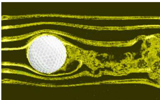
Obr. 15 Vizualizace proudnic při obtékání míčku pomocí vodíkových bublinek [24]
