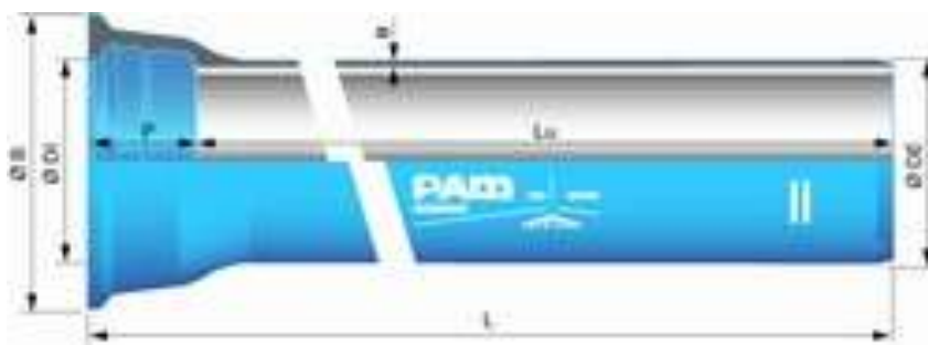
Obr.č. 3: Litinové potrubí Natural (Saint – Gobain)
