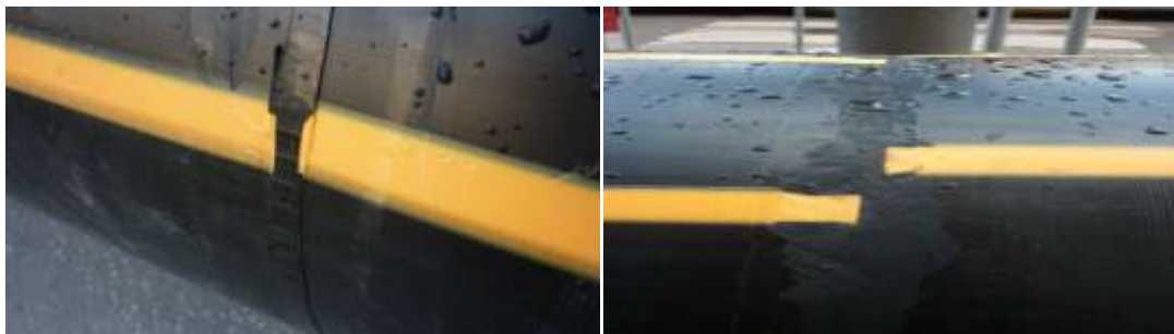
Obr. č.9: Svár na tupo a) správně odstraněn návarek, b) nesprávně odstraněn návarek
