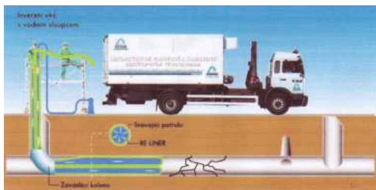
Obr. č. 26: Inverzování (Revak s.r.o.)
