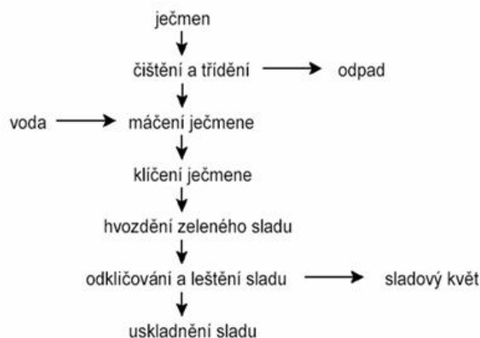
Obr. 21: Schéma výroby sladu
