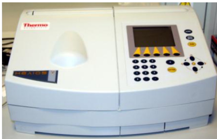
Obr. 31: Jednopaprskový spektrofotometr UNICAM Helios \gamma
