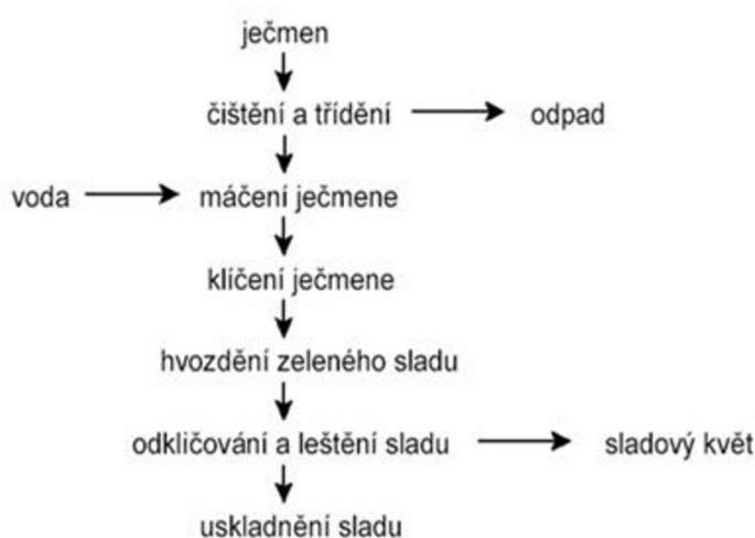
Obr. 21: Schéma výroby sladu
