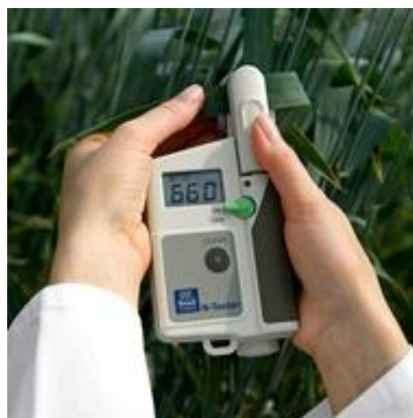
Obrázek 2.10 – Princip měření chlorofylmetru ( www.yara.com ) a přístroj Yara N-Tester ( www.yara.us )
