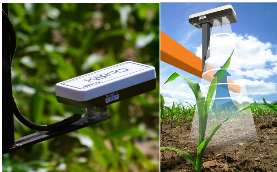
Obrázek 2.18 – Přístroj OptRx a princip měření ( http://www.agleader.com/ )
