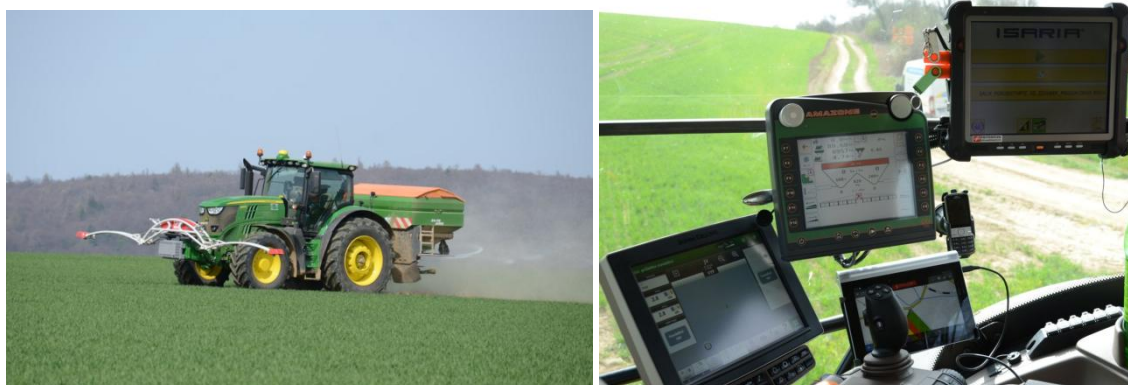
Obrázek 4.6 – Souprava při aplikaci produkčního hnojení a pracoviště traktoristy s palubním terminálem traktoru, rozmetadla a systému Isaria (foto: V. Lukas)
