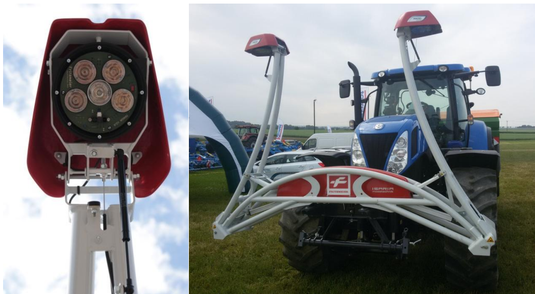
Obrázek 2.12 – Hlavice senzoru Isaria se 4 aktivními LED diodami ( http://fritzmeier-umwelttechnik.com ) a senzory Isaria v přepravní poloze (foto: J. Mezera)
