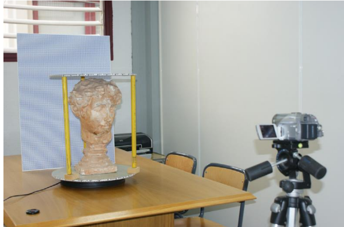
Obr. 2.1. Způsob testování videogrammetrie (Herrález a kol. 2016).
