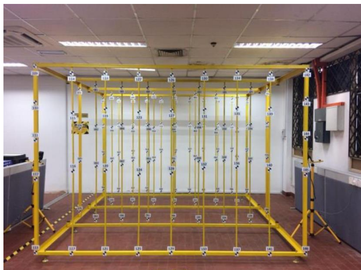
Obr. 2.2 Kalibrace kamer (Ahmad a kol 2019).
