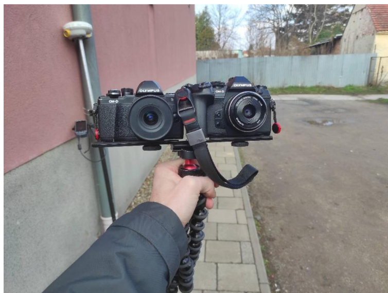
Obr. 4.26 Umístění kamer na úchytu.
