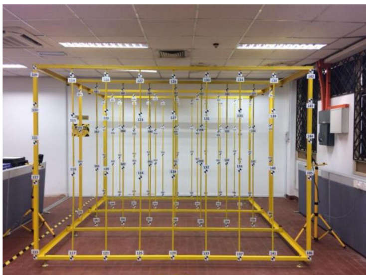
Obr. 2.2 Kalibrace kamer (Ahmad a kol 2019).
