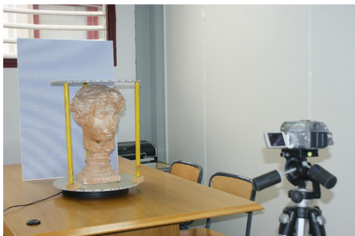
Obr. 2.1. Způsob testování videogrammetrie (Herrález a kol. 2016).
