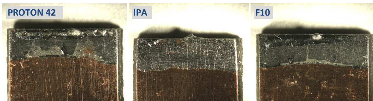
Obrázek 32 Povrch pájky na Cu vzorku po UZV čištění
