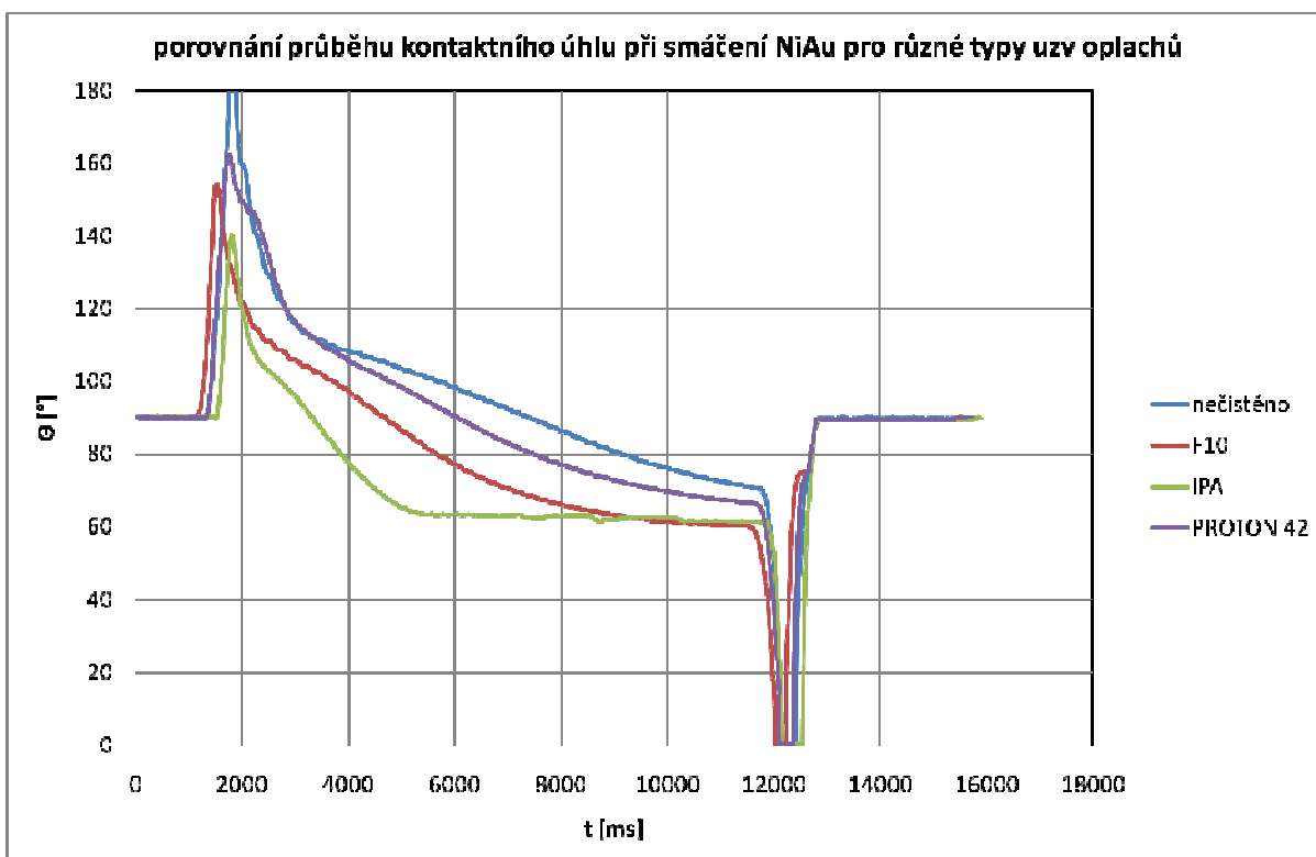
Obrázek 18 Porovnání průběhů kontaktního úhlu při smáčení povrchové úpravy DPS NiAu
