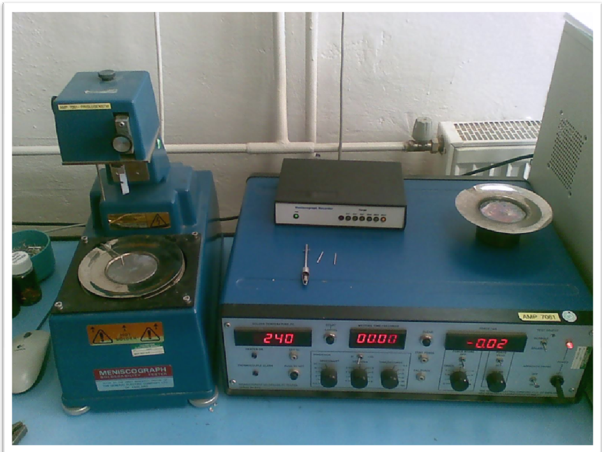
Obrázek 5 Fotografie měřicího pracoviště s meniskografem MK6A
