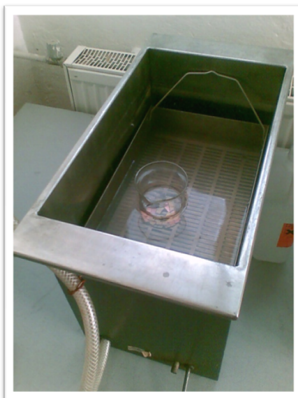
Obrázek 13 Čištění vzorků v ultrazvukové myčce
