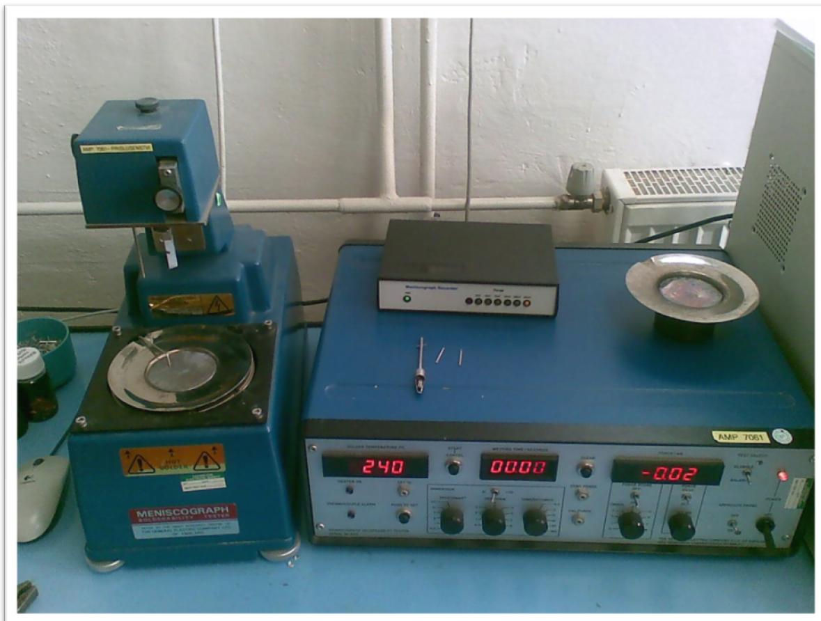
Obrázek 5 Fotografie měřicího pracoviště s meniskografem MK6A
