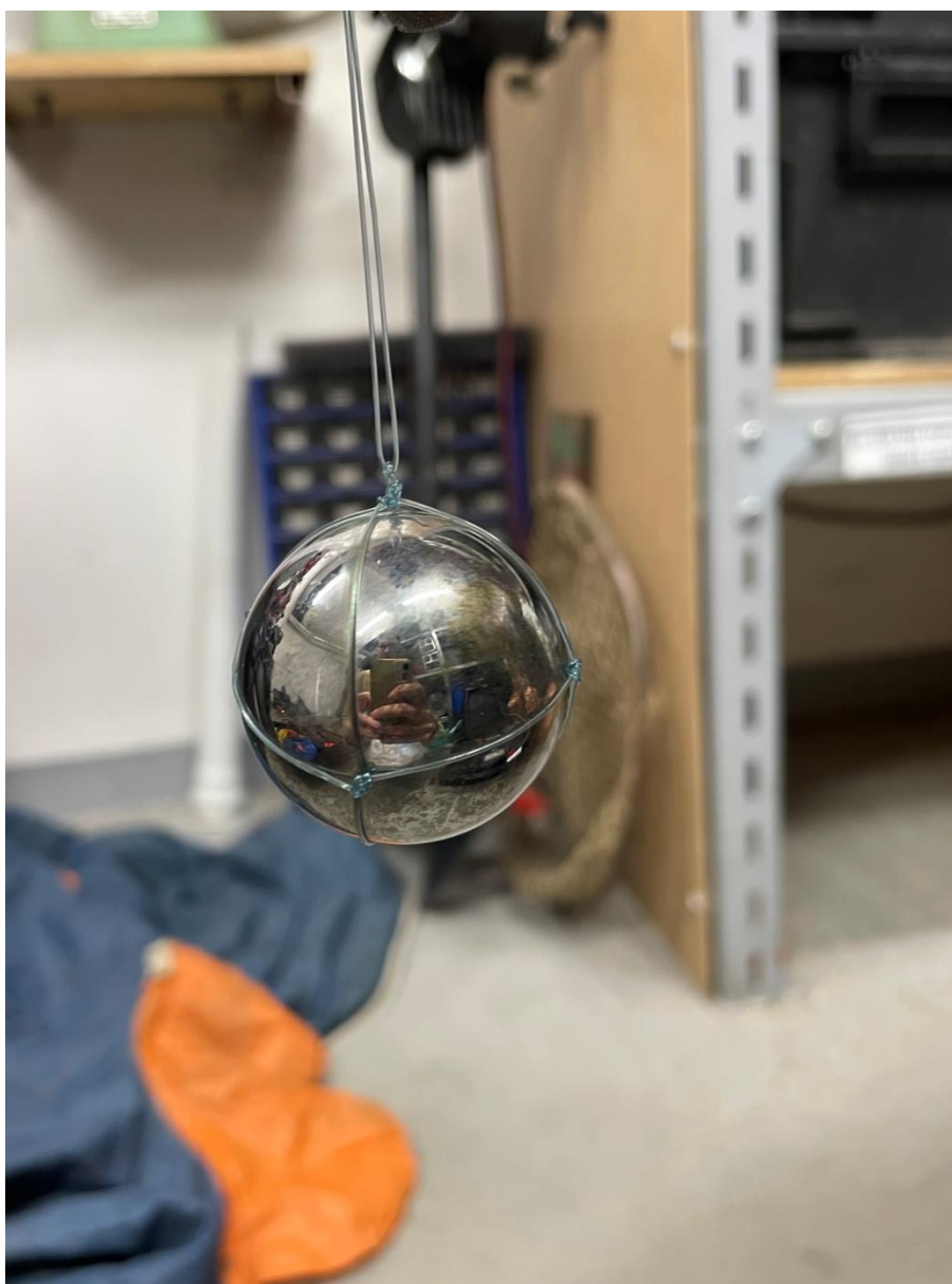
obr. 21: kalibrační koule (foto vlastní)
