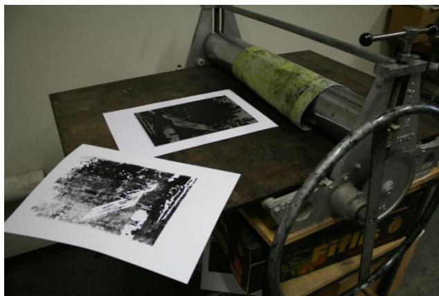
Obrázek 5.7 - Zkušební výtisk – správný tlak lisu
