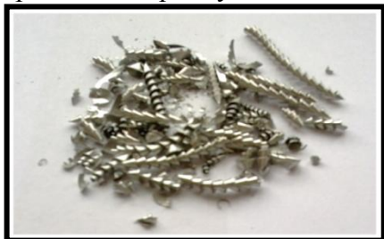
Fotografie třísky při obrábění s přívodem kapaliny ESOK 1.0D
