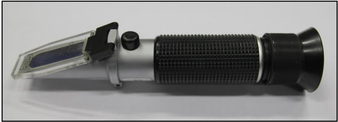
Obr. 29: Refraktometr Optech Brix [16]
