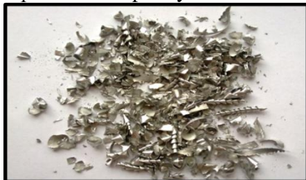
Fotografie třísky při obrábění s přívodem kapaliny ESOK 1.1.F
