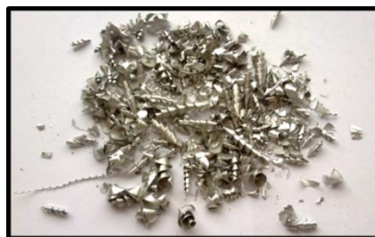
Fotografie třísky při obrábění s přívodem kapaliny ESOK 1.0E
