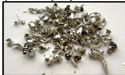
Fotografie třísky při obrábění s přívodem kapaliny ESOK 1.1B
