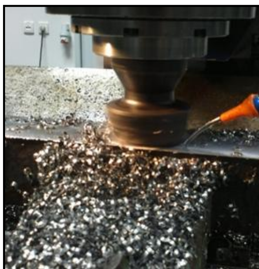
Obr. 4: Přívod procesní kapaliny do místa řezu v praxi
