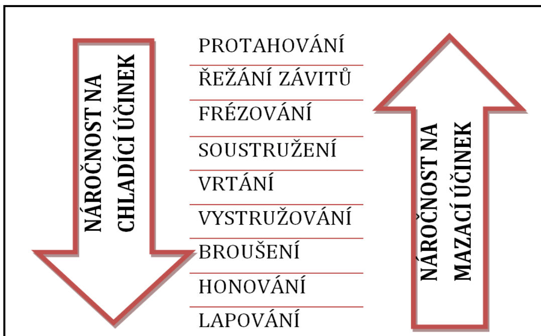
Obr. 3: Požadavky na procesní média při různých technologiích obrábění [5]
