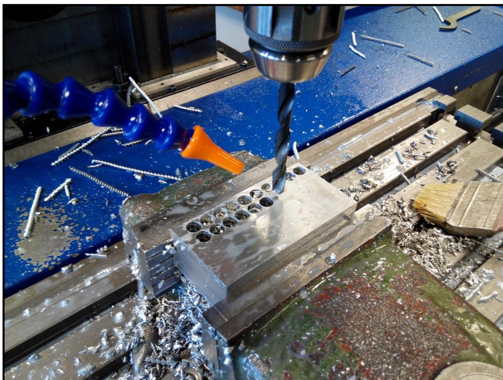
Obr. 30: Nástroj nad obrobkem připravený k vrtání
