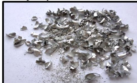
Fotografie třísky při obrábění bez kapaliny – vzduch
