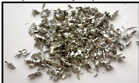
Fotografie třísky při obrábění s přívodem kapaliny voda
