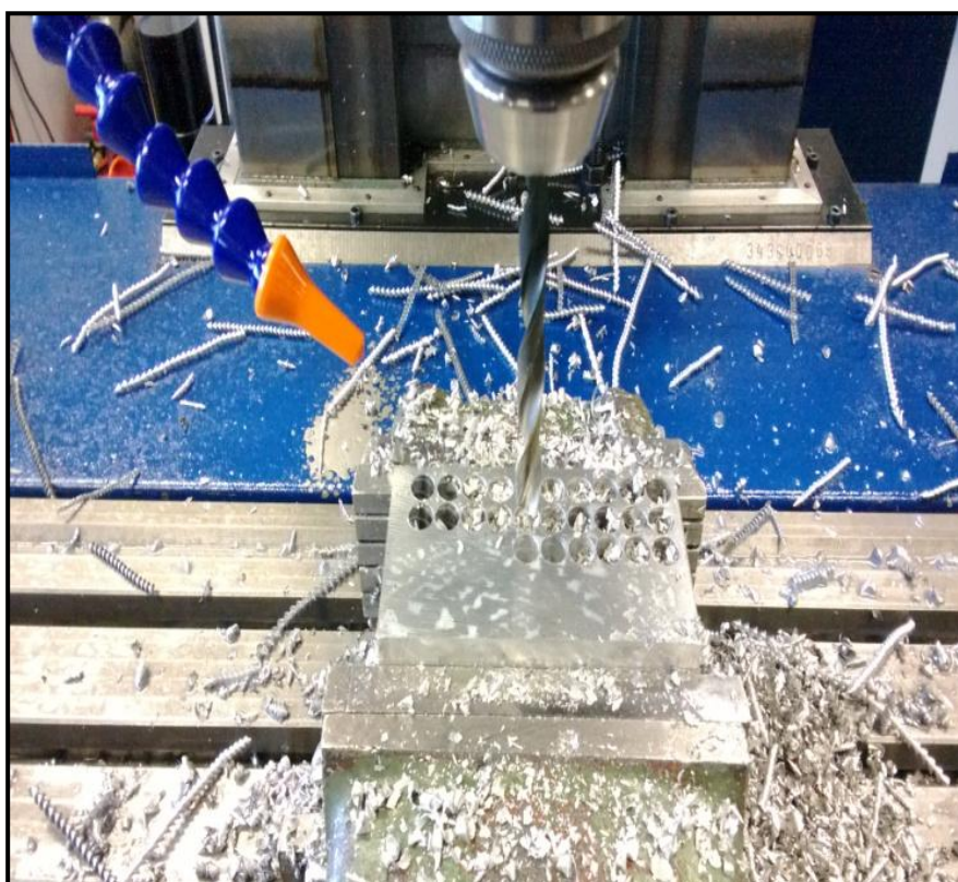
Obr. 31: Třísky vzniklé při vrtání
