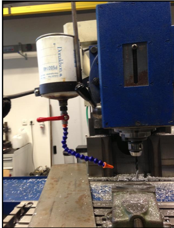
Obr. 25: Přívod chladicí kapaliny z nádrže
