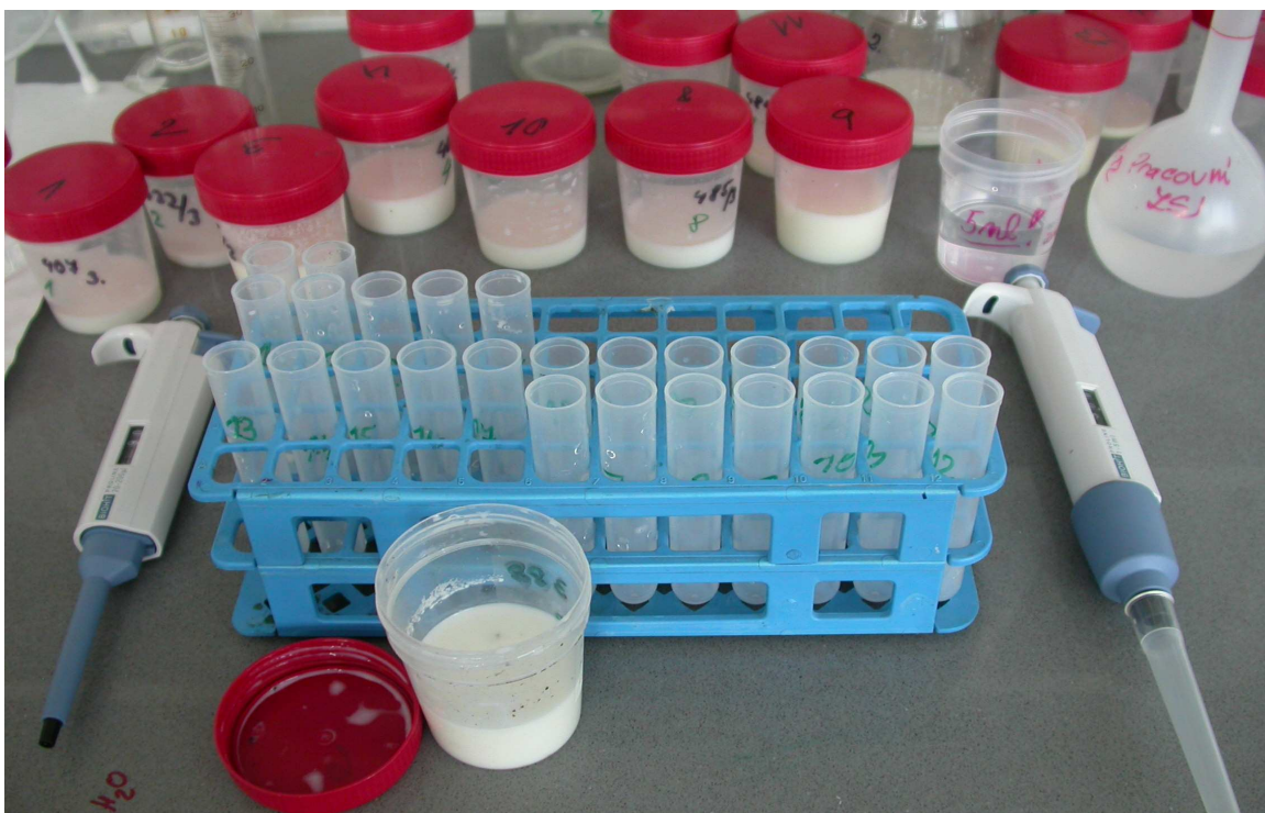
Obr. 4 Příprava vzorků pro zinksulfátovou reakci
