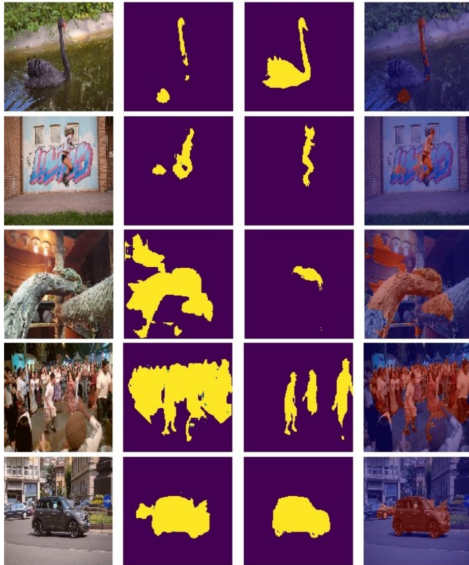
Obrázek 27: Ukázka neúspěšných segmentací z DAVIS sady. Zleva: vstupní snímek, vypočítaná segmentace, ručně anotovaná segmentace, vypočítaná segmentace překrytá přes vstupní obraz.
