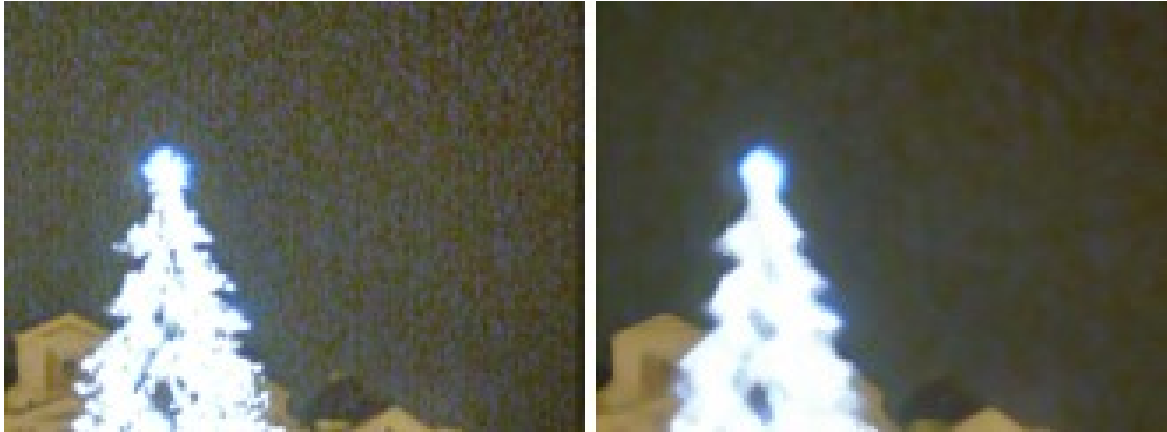
Obrázek 3: Vyhlazení obrazu pomocí mediánového filtru. Dochází k odstranění šumu v oblasti oblohy při zachování důležitých hran.
