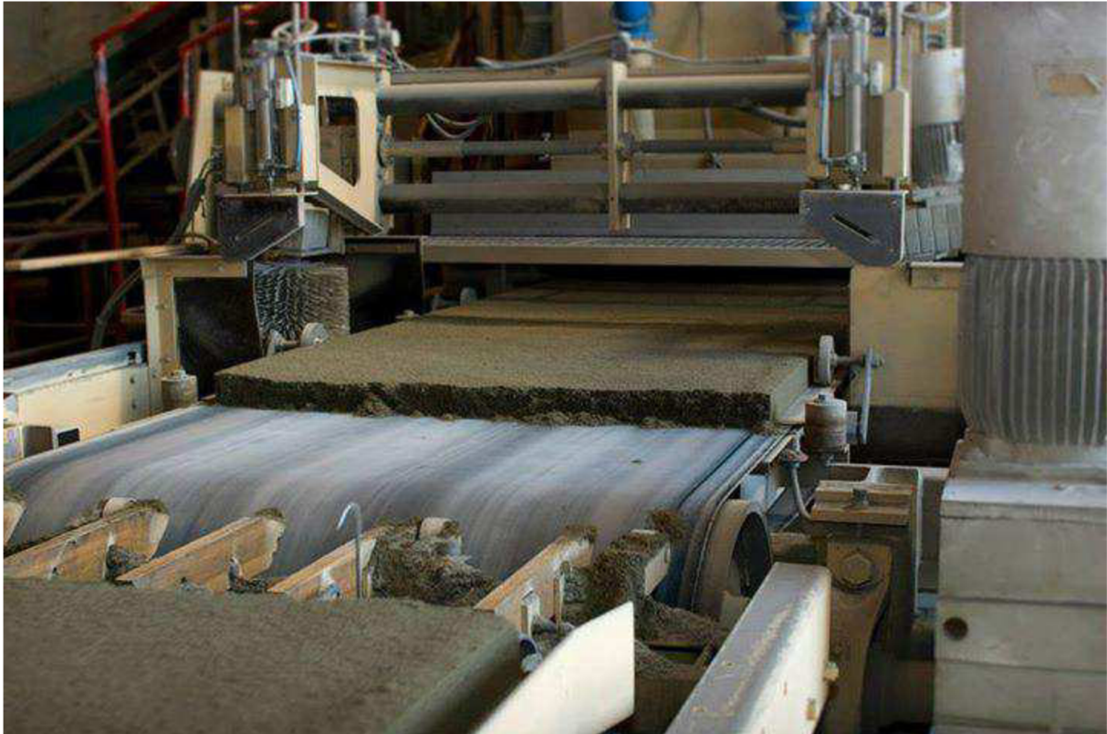
Obrázek 2: Ukázka výroby cementotřískových desek [10]
