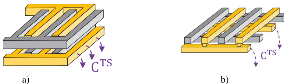
Obrázek 10: Kapacitor vytvořený z prokládaných vodičů a) jedním směrem b) oběma směry (převzato z [4])
