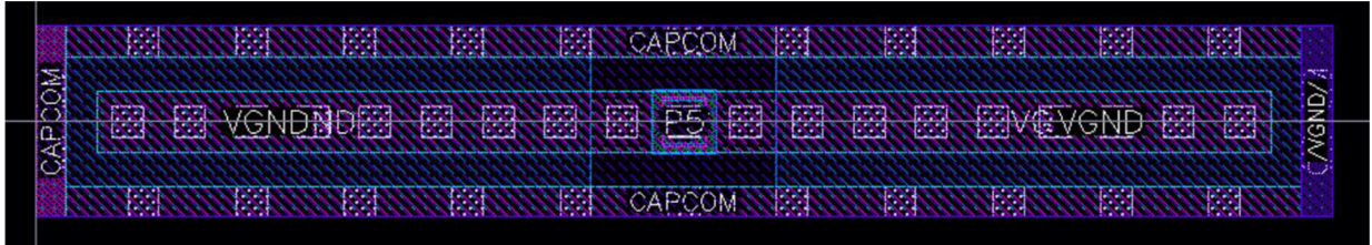
Obrázek 15: Navržený MOM kapacitor
