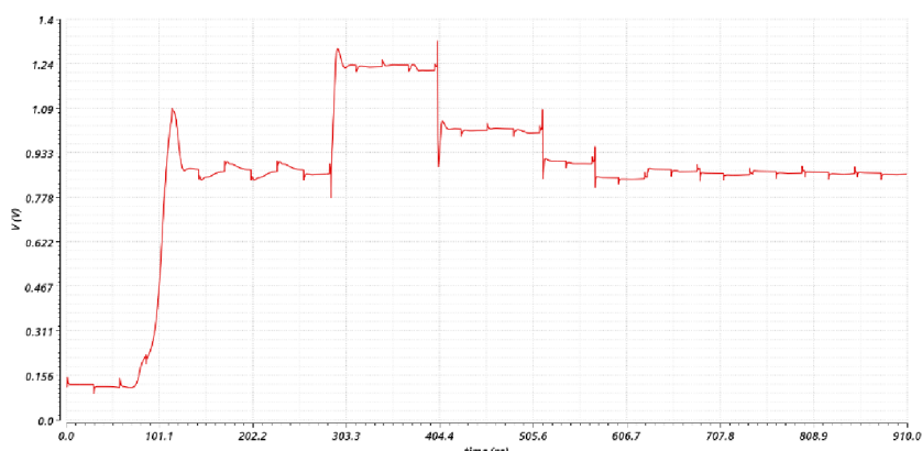
Obrázek 54: Časový průběh napětí v uzlu CAPCOM s modulovaným napájecím napětím signálem 0,1 CLK
