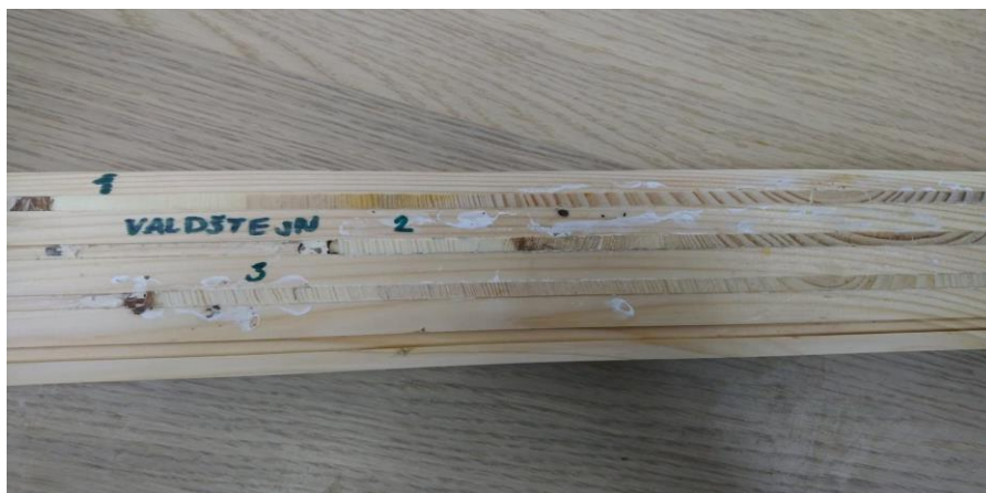
Obrázek 16: Vývrvtý jednotlivých borovic odebrané Presslerovým nebozezem a připravené po zbroušení na vlastní analýzu.
