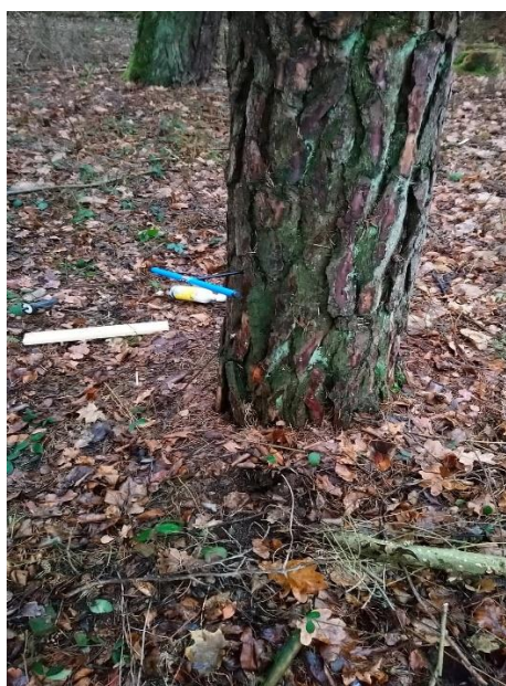
Obrázek 18: Odběr vzorku Presslerovým nebozezem, zdroj Tereza Dudová.
