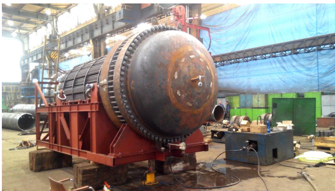
Obr. 24 Tlaková zkouška výměníku s U-trubkami
