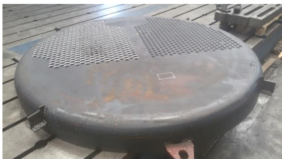
Obr. 26 Trubkovnice s otvory
