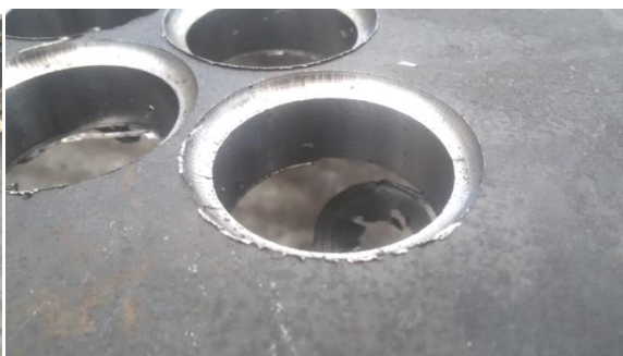
Obr. 27 Otvor v trubkovnici s odlehčovací drážkou
