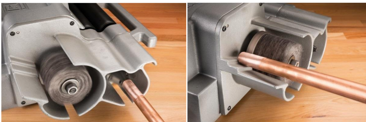
Obr. 36 Mechanické čištění trubek strojkem RIGID [8]
