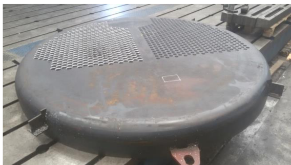
Obr. 26 Trubkovnice s otvory
