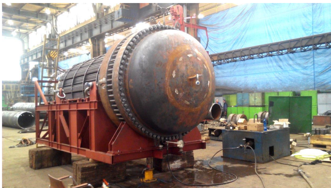
Obr. 24 Tlaková zkouška výměníku s U-trubkami
