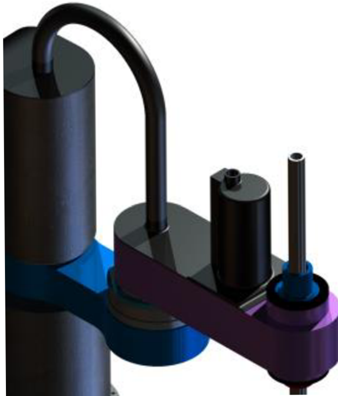
Obrázok 38: Plastová trubica a kryt motoru M4 s vývodom pre káble
