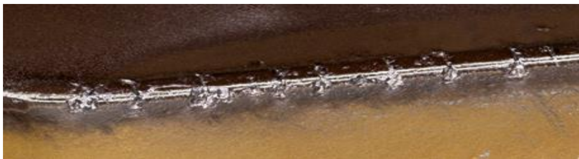
Obr. 3.14 Hrebeňovité trhliny na ostrí nástroja [5]
