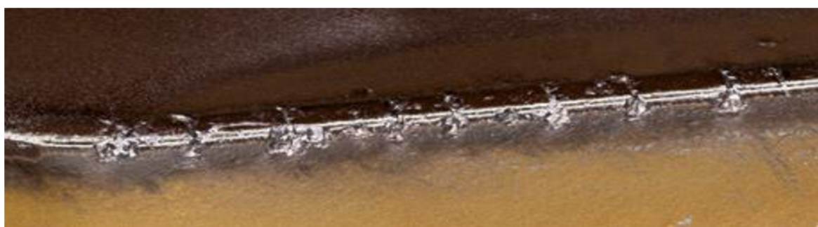
Obr. 3.14 Hrebeňovité trhliny na ostrí nástroja [5]
