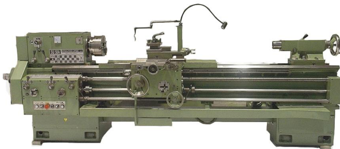
Obr. 4.1 Univerzálny hrotový sústruh SU50A-SP TOS Kuřim a.s. [27]
