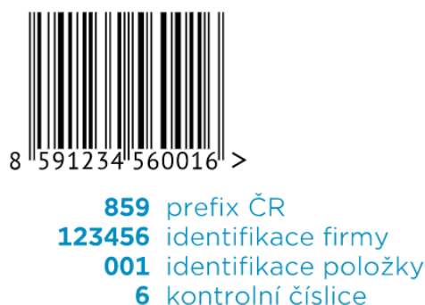
Obr. 14 Schéma EAN13 [2]
