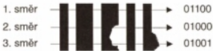
Obr. 5 Ukázka a důsledek mech. poškození kódu [1]
