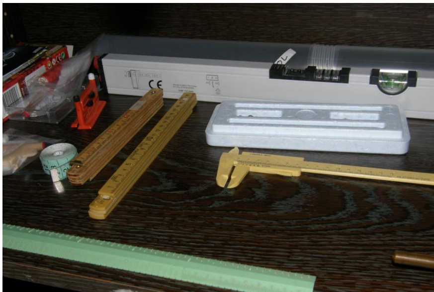
Obr. 4 Skládací metr a posuvné měřítko opatřené bodovými výstupky. V pozadí můžeme vidět vodováhu.
