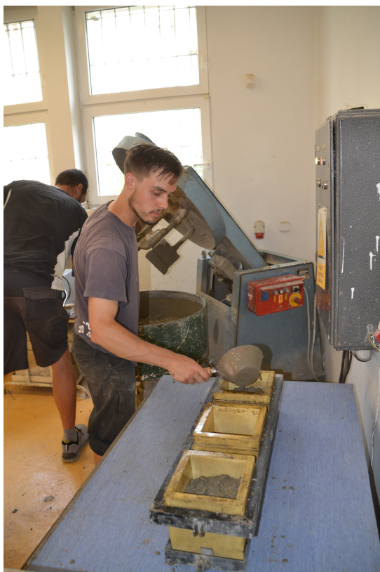
Obr. 13: Plnění betonu do forem ( archiv P. Cikrle ).
