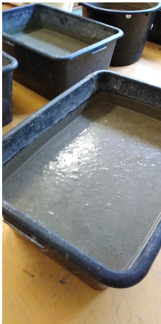
Obr. 11: Segregovaný beton po převezení do laboratoře.
