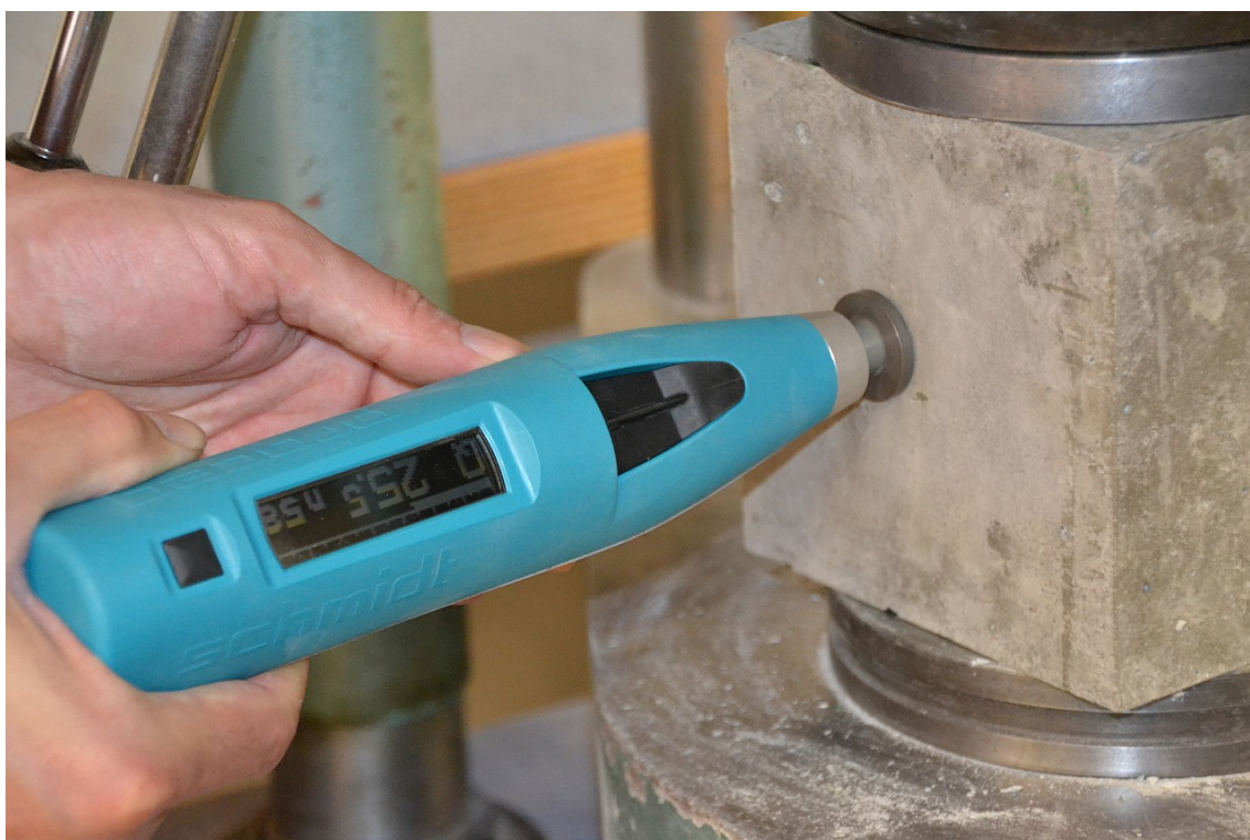
Obr. 17: Měření tvrdosti přístrojem SilverSchmidt PC-L s hříbovitým nástavcem (archiv P. Cíkrle).
