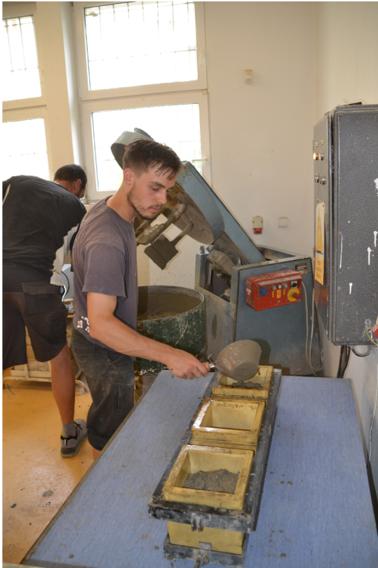
Obr. 13: Plnění betonu do forem ( archiv P. Cikrle ).
