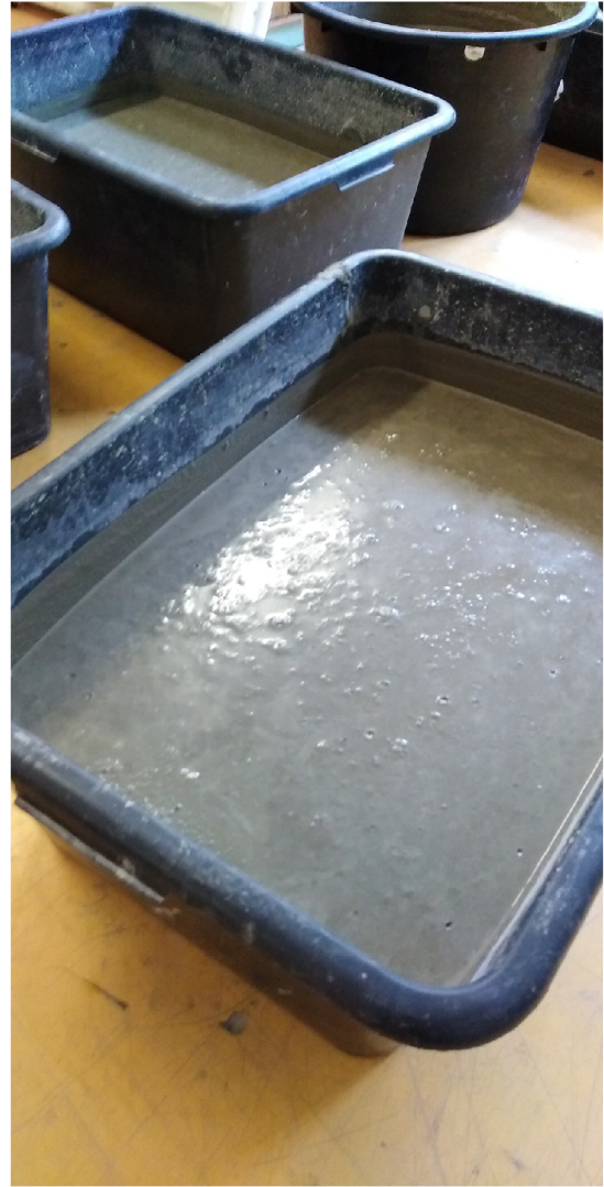
Obr. 11: Segregovaný beton po převezení do laboratoře.
