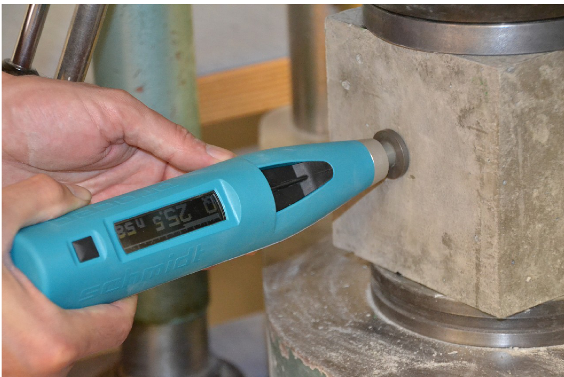
Obr. 17: Měření tvrdosti přístrojem SilverSchmidt PC-L s hříbovitým nástavcem (archiv P. Cikrle).
