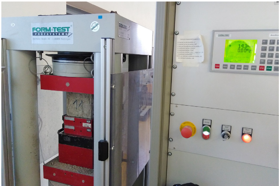
Obr. 18: Měření pevnosti v tlaku v laboratoři.
