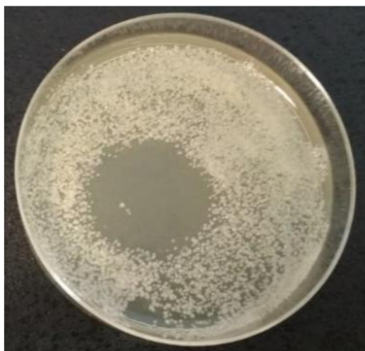
Obrázok 20: Zobrazenie najväčšej inhibičnej zóny vytvorenej v experimente pôsobením mikrovlnného výboja s výkonom 12 W po dobu 300 s na 10-násobne zriedenú kultúru kvasinky Candida glabrata po 48 hodinách kultivácie
