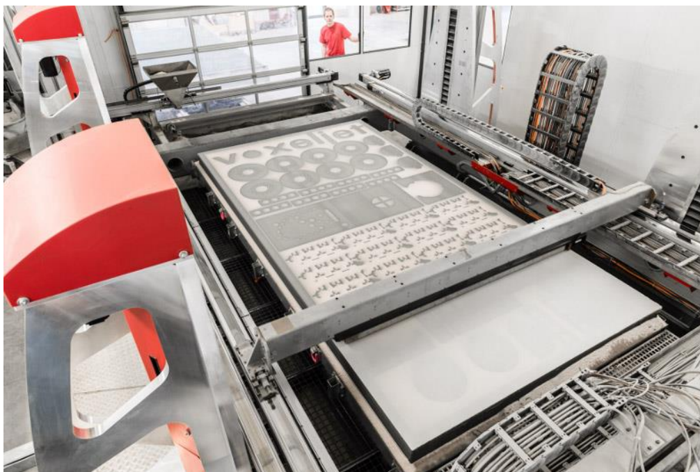
Obr. 8) Tiskárna Voxjet VX4000 pro vytváření pískových forem na odlévání [6]
