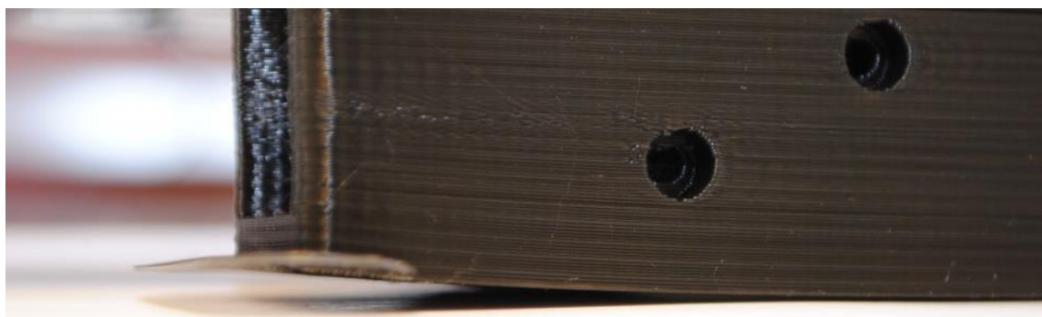
Obr. 17) Warping – odloupenutí rohu při chladnutí [12]
