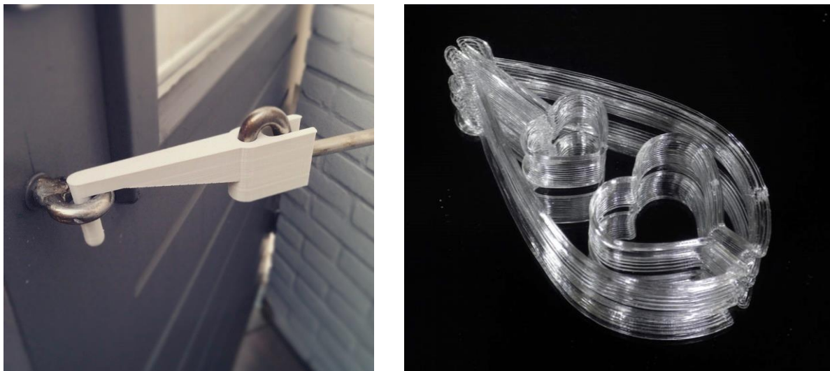
Obr. 18) PET modely [12] a) prodloužení háku na dveře b) průhledný výtisk
