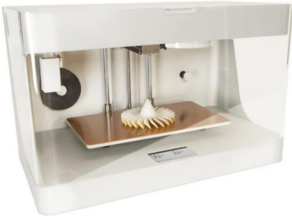
Obr. 39) Granolite jako podklad pod model z nylonu [15]
