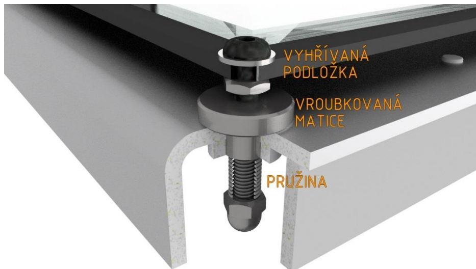
Obr. 99) Nastavování výšky podložky
