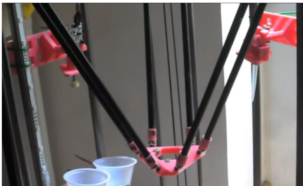
Obr. 54) AVTH na tiskárně typu Delta, nahoře vpravo a vlevo jsou zásobníky na hlavy [32]
