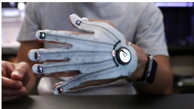
Obr. 42) Vytisknutý model se zapojenými LED diodami [26]
