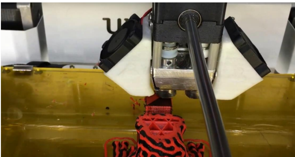
Obr. 44) Ukázka z tisku dvoubarevného modelu, v zadní části je pomocná kostka [28]
