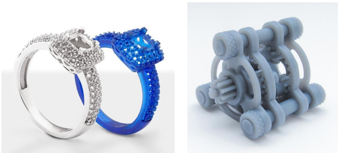
Obr. 3) Ukázka tisku SLA technologií [5] a) šperkařský průmysl, b) tisk funkční planetové převodovky
