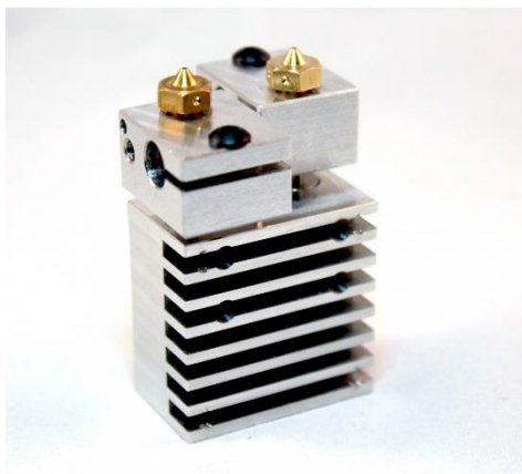
Obr. 33) a) vícenásobný hot end Chimera (E3D) a b) vícebarevný výtisk [19]
