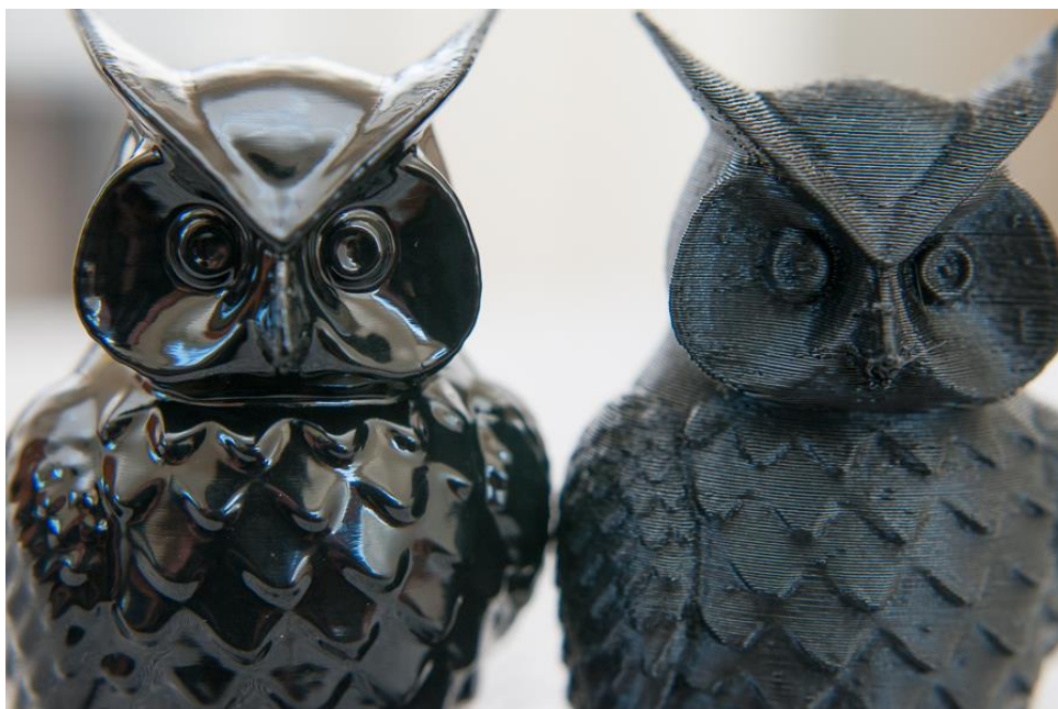
Obr. 16) ABS vyleptaný vs. nevyleptaný [12]
