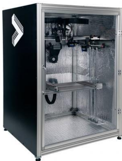
Obr. 30) Rám průmyslové tiskárny AON-M z hliníkových profilů [3]
