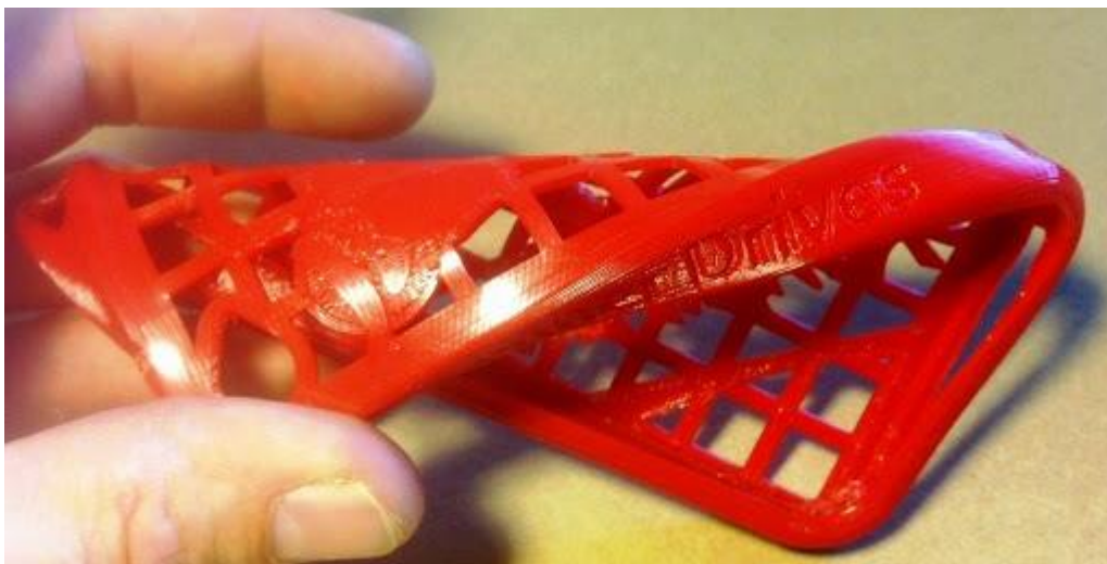
Obr. 22) Pružný výtisk TPE [12]
