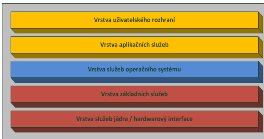
Obr. 3.2: Model vrstev operačního systému Symbian [8].
