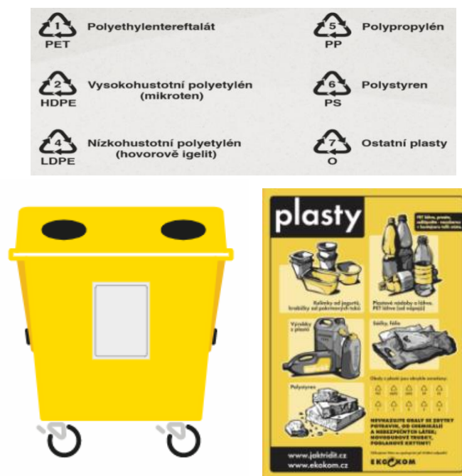
Obr. č. 11 - a, b, c – Schéma symbolů pro druhy odpadů, obrázek sběrné nádoby a informační nálepka, a) symboly pro druhy odpadů b) nádoba pro sběr plastu c) informační nálepka pro plasty (zdroj: EKO-KOM)
